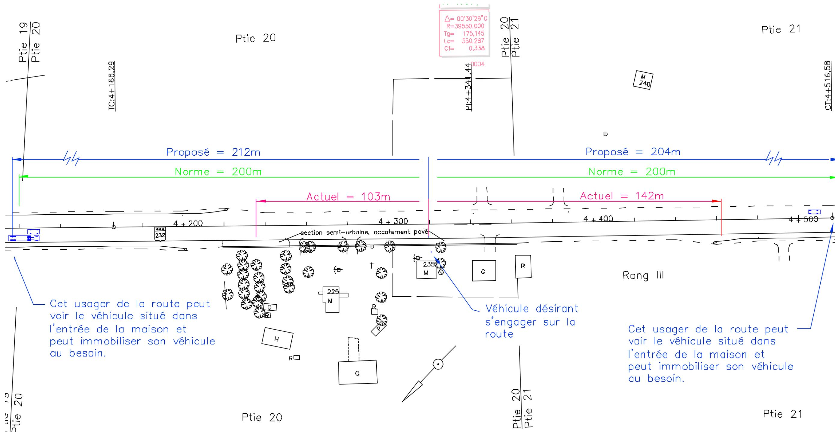
Distance de visibilité d'arrêt à l'endroit de l'entrée pour un véhicule se dirigeant en cette direction
