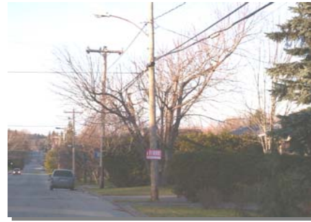
Arbres élagués en 'V' pour fin de dégagement du réseau électrique triphasé sur la rue de l'Ontario au coin de la rue Leclerc.
