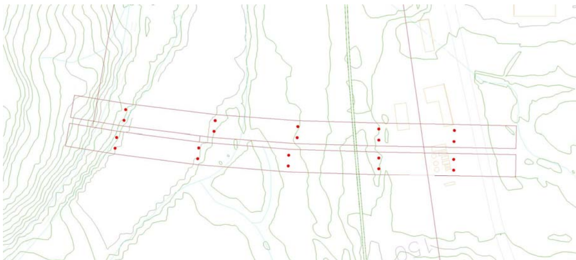
Figure 6.2.1 Vue en plan des piles et de l'ouverture libre projetée – Autoroute 410 P-11935N, P-11935S
