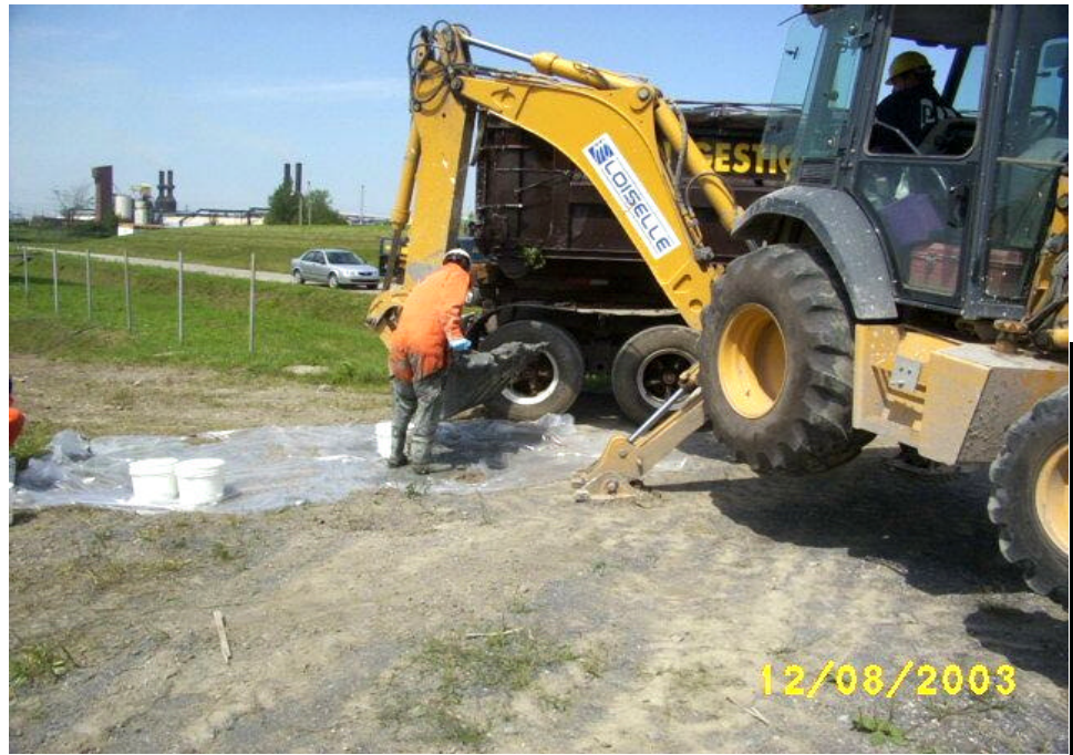
Photo n° 15. Prélèvement des échantillons dans la benne # 1, suite au transport, à l'aide d'une rétrocaveuse
