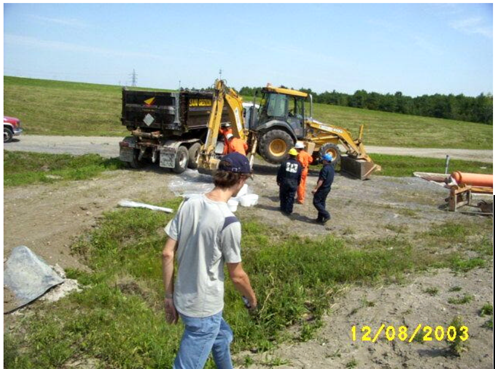
Photo n° 14. Prélèvement des échantillons dans la benne # 1, suite au transport à l'aide d'une rétrocaveuse
