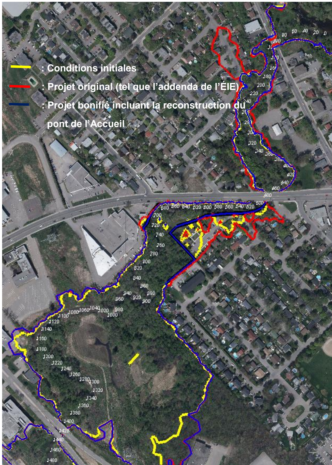
Figure QC-128-8 Limites approximatives de la crue centennale dans le secteur aval de la rivière Lorette en conditions initiales, pour le projet original et pour le projet bonifié en tenant compte de la reconstruction du pont de l'Accueil.
