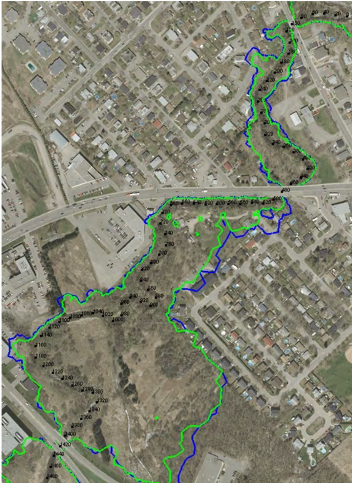
Figure 4-2 Limite approximative de la crue centennale dans le secteur aval de la Lorette en conditions initiales et futures.
