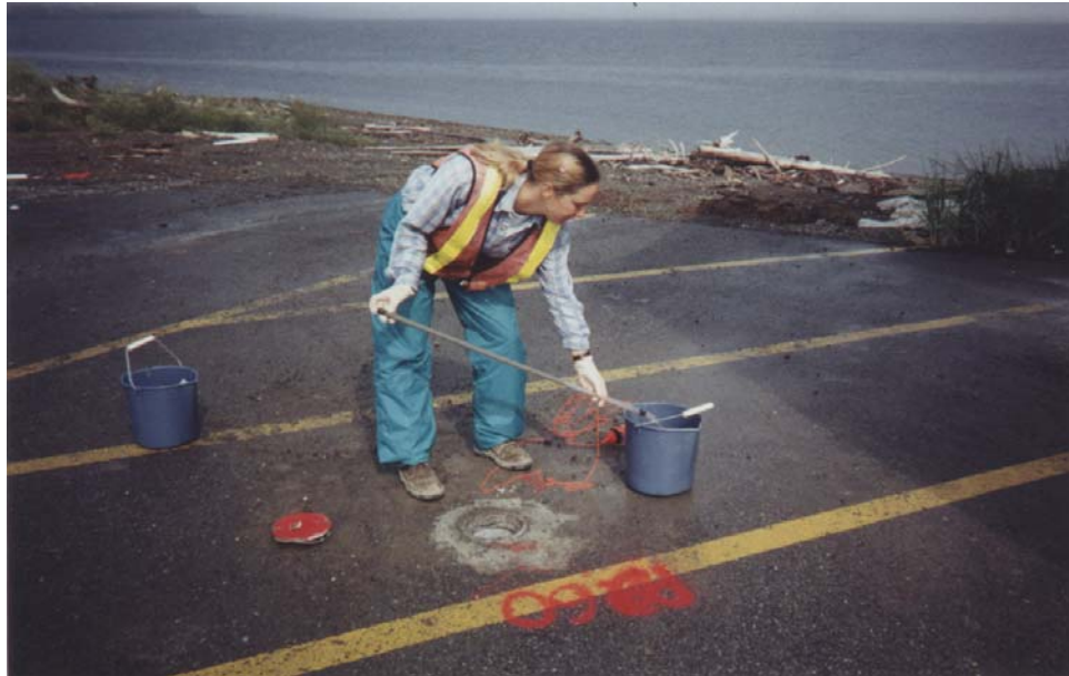
Photo 13 : Purge de l'eau souterraine de tous les puits avant l'échantillonnage à l'aide d'un échantillonneur à bille. L'eau de purge est récupérée pour être ensuite traitée. (10-08-03)
