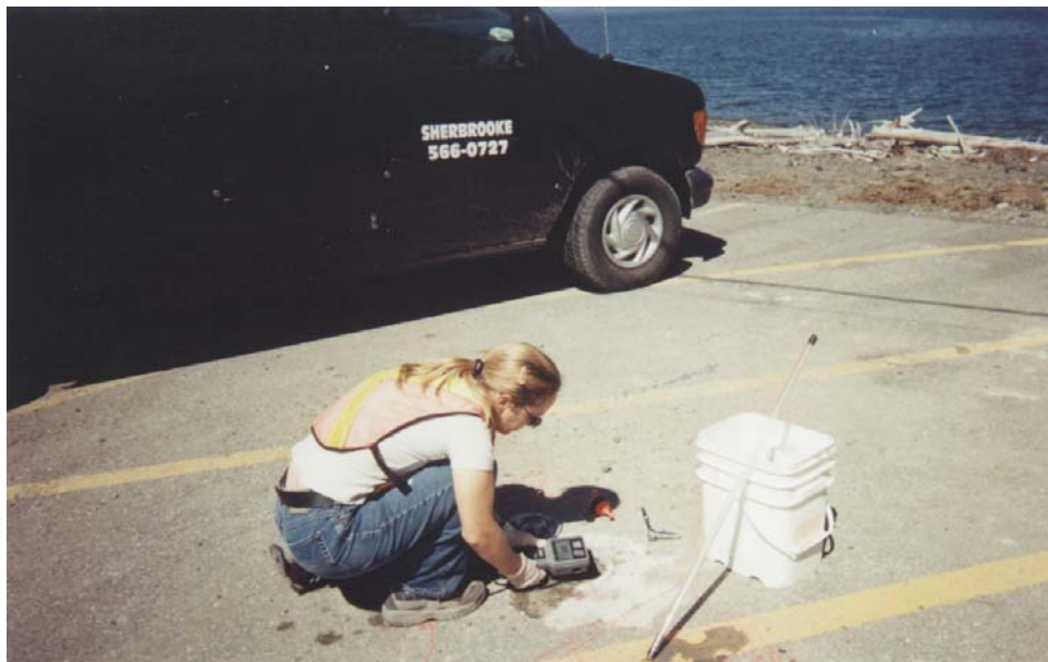
Photo 14 : Prise des mesures physico-chimiques dans tous les puits : oxygène dissous, température, pH, conductivité et potentiel d'oxydo-réduction. (11-08-03)
