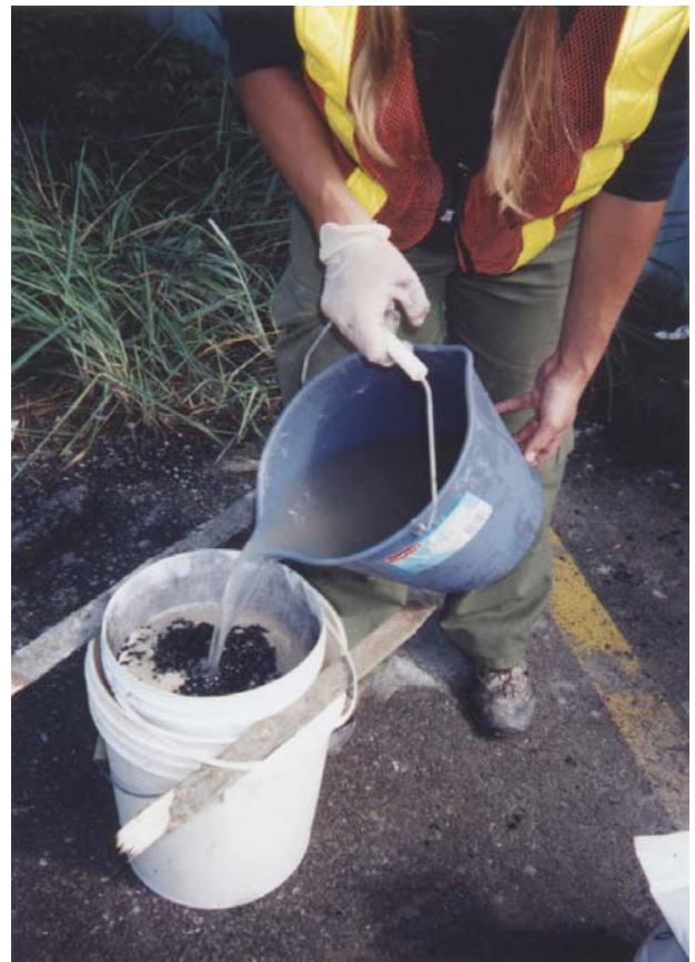
Photo 16 : Traitement de l'eau de purge avec des charbons actifs. L'eau une fois traitée a été échantillonnée pour l'analyse des métaux et des C 10 -C 50 avant de déterminer son lieu de disposition. (12-08-03)
