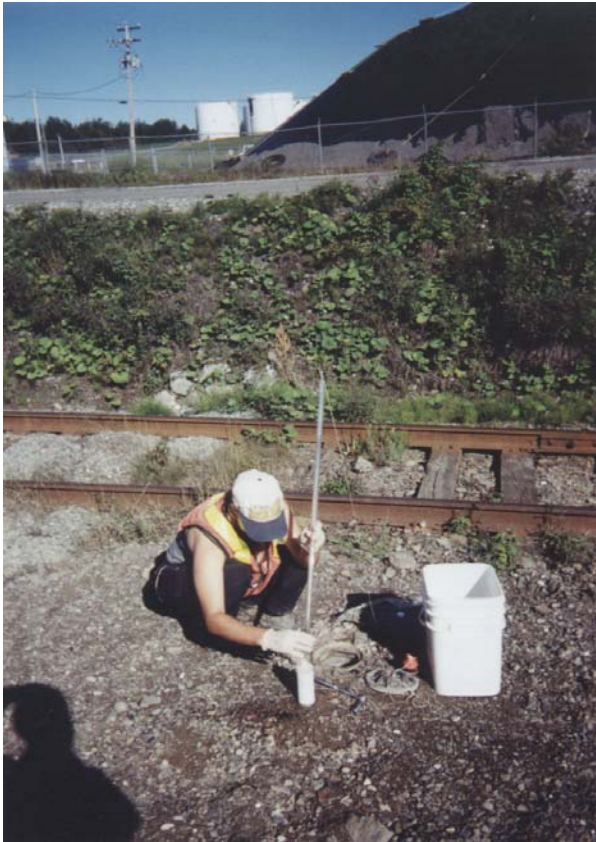
Photo 15 : Échantillonnage de l'eau souterraine à l'aide d'un échantillonneur à bille qui est assigné au puits en permanence afin de s'assurer de l'intégrité des échantillons. (12-08-03)
