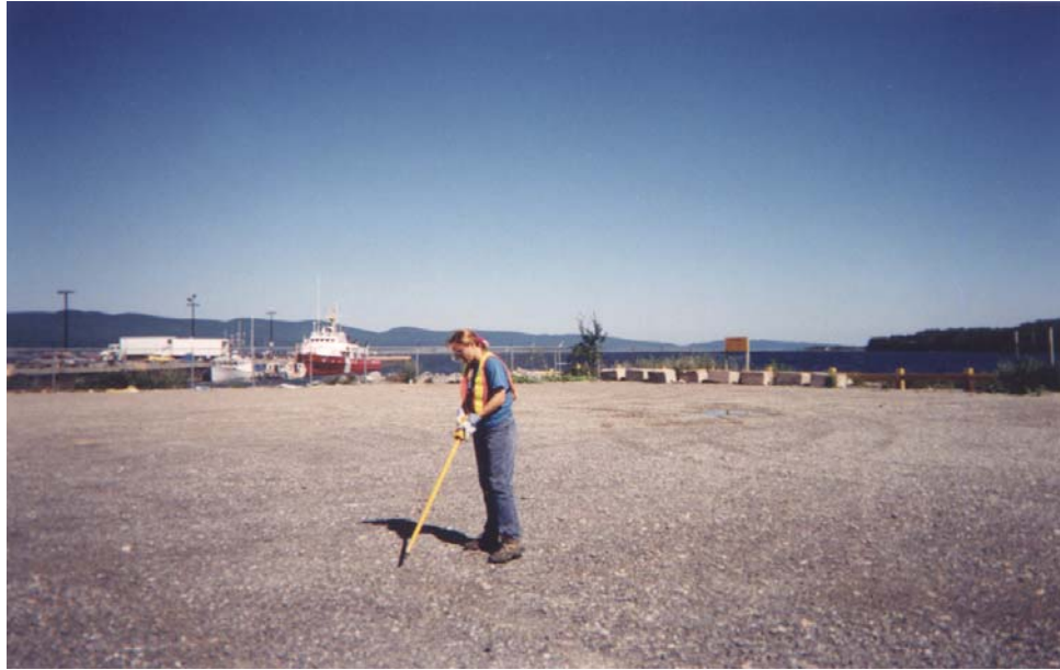
Photo 1 : Recherche des anciens puits d'observation à l'aide d'un détecteur de métal (lot 1-4). Un horizon de gravier a été disposé sur l'ensemble de l'aire de stationnement et autour du hangar (0,3 m). (30-07-03)
