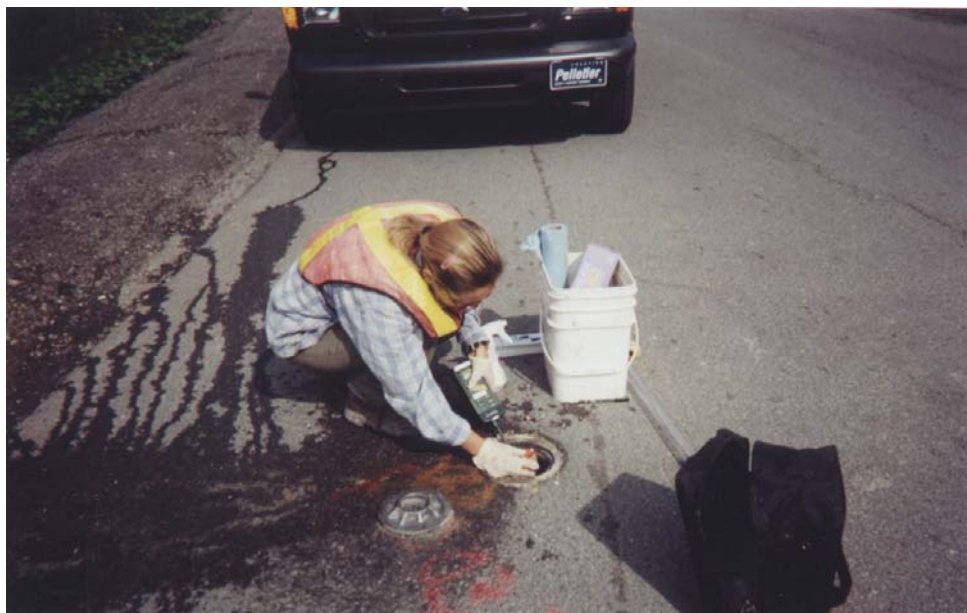
Photo 12 : Tournée piézométrique et prise des valeurs d'émanation de gaz à l'ouverture du puits à l'aide d'un lecteur portatif de vapeurs organiques (Minirae). (10-08-03)
