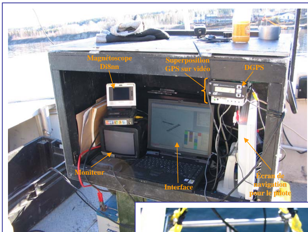
PHOTO 3 — Instrumentation utilisée pour la description des habitats aquatiques ; l'interface informatique pour classer et géoréférencer les observations visuelles en temps réel est affichée sur l'écran de l'ordinateur
