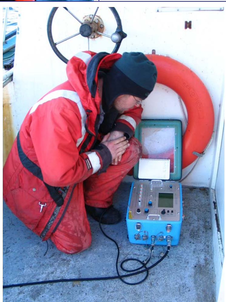
PHOTO 6 — Unité de surface pour la lecture en temps réel du courant
