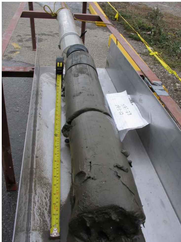
PHOTO 1 — Carottage des sédiments en plongée à partir du GRT Cadence (Moules Forillon inc.)
