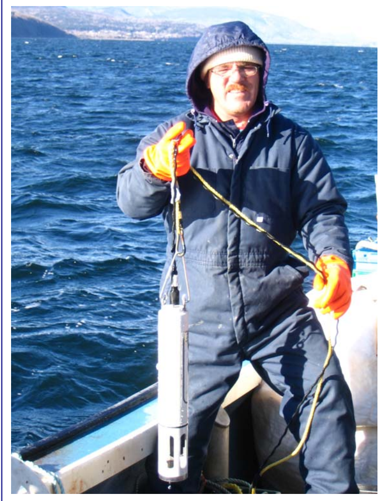
PHOTO 7 — Sonde multiparamètre DS4 utilisée pour les profils CTD
