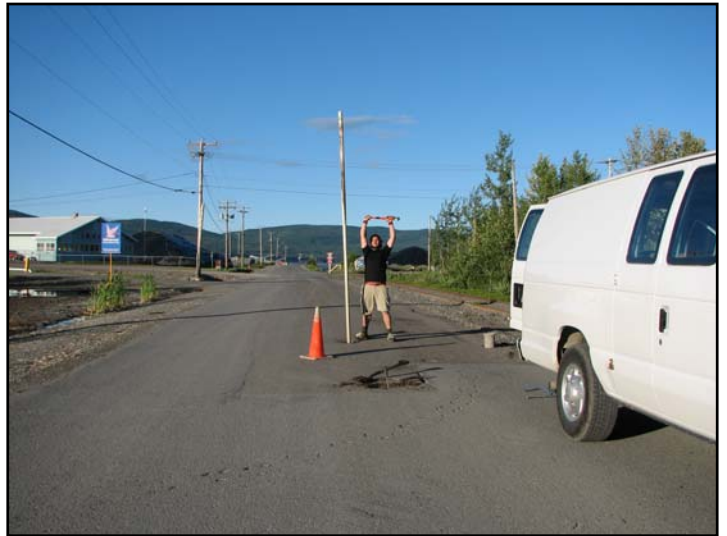
Photo 23 : Puits d'observation PO-7 sans bouchon ni boîte de protection, complètement rempli.
