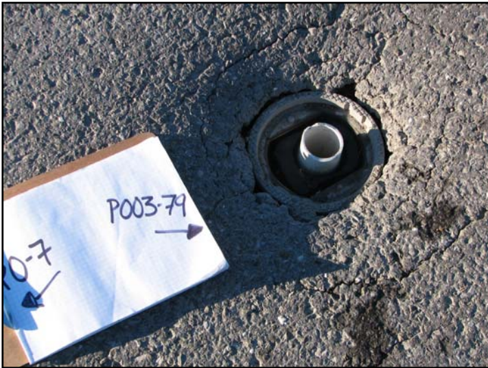
Photo 24 : Puits d'observation PO03-79 sans couvercle ni bouchon
