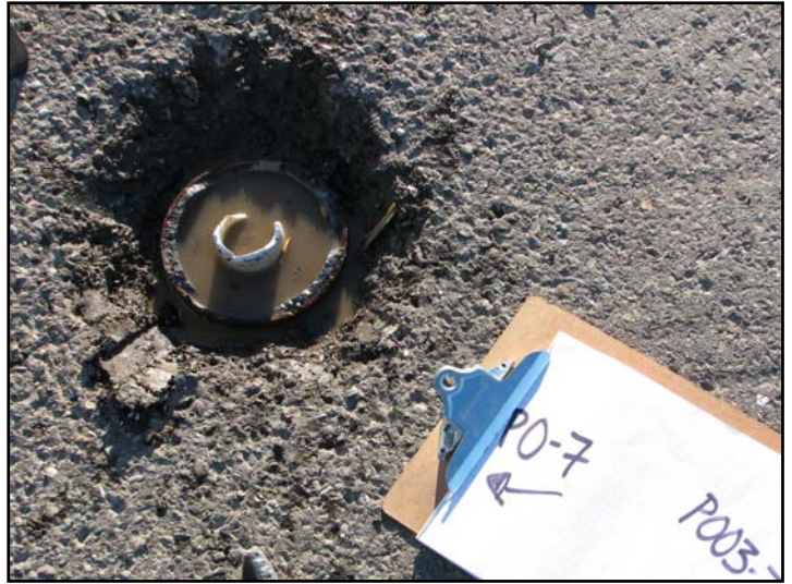
Photo 23 : Puits d'observation PO-7 sans bouchon ni boîte de protection, complètement rempli.
