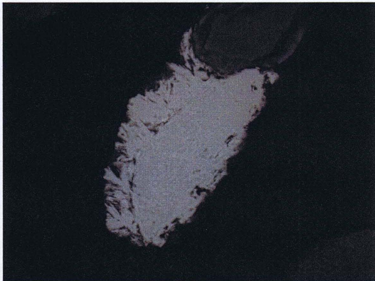
Figure 6 : T1016 24C -100+200. Sulfure de cuivre partiellement ( 1/5^{\circ} ) associé à du quartz (BSE).
