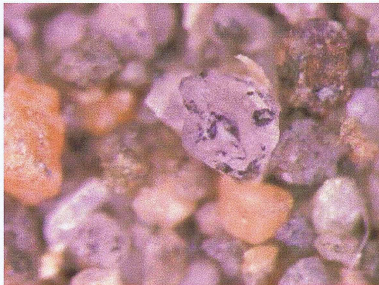
Figure 1 : T1016 24C -16 +100. Un grain de quartz présentant des taches noires. Ces taches sont associées à la présence d'huiles lourdes. / Proportion estimée visuellement : 1 à 10 % de la surface des grains. Les feldspaths adjacents portent également des traces noires, bien que moins facilement repérables.
