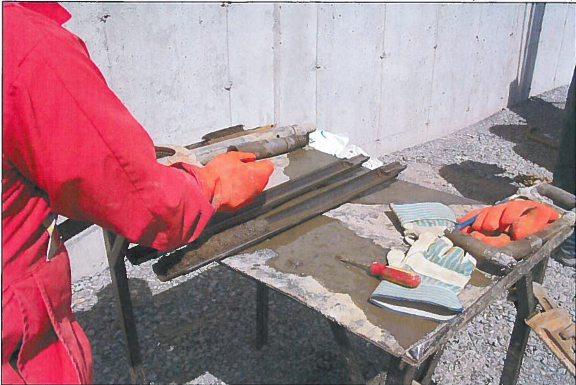
Photo 13 : Forage F09-02, échantillonnage du sol (4 mai 2009).
