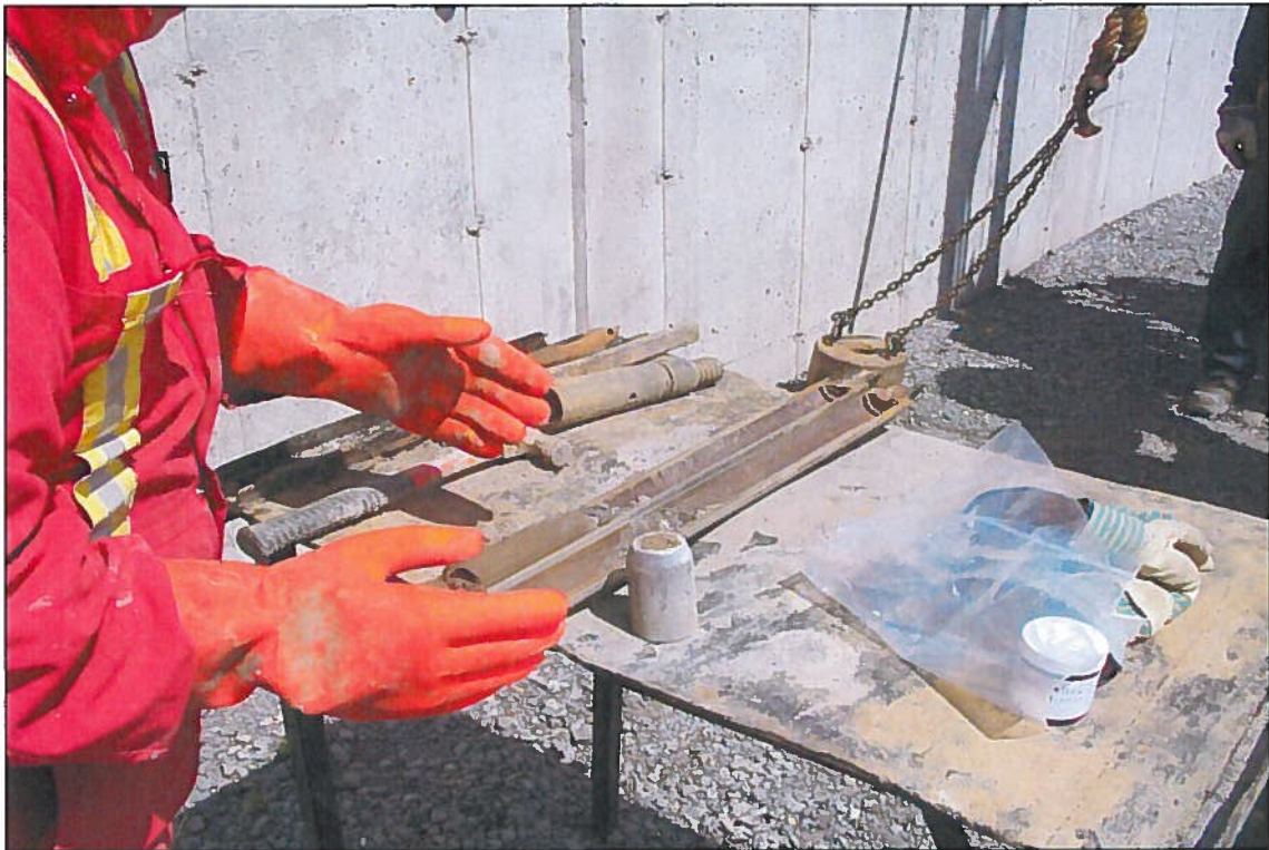
Photo 9 : Forage F09-02, échantillonnage du sol (4 mai 2009).
