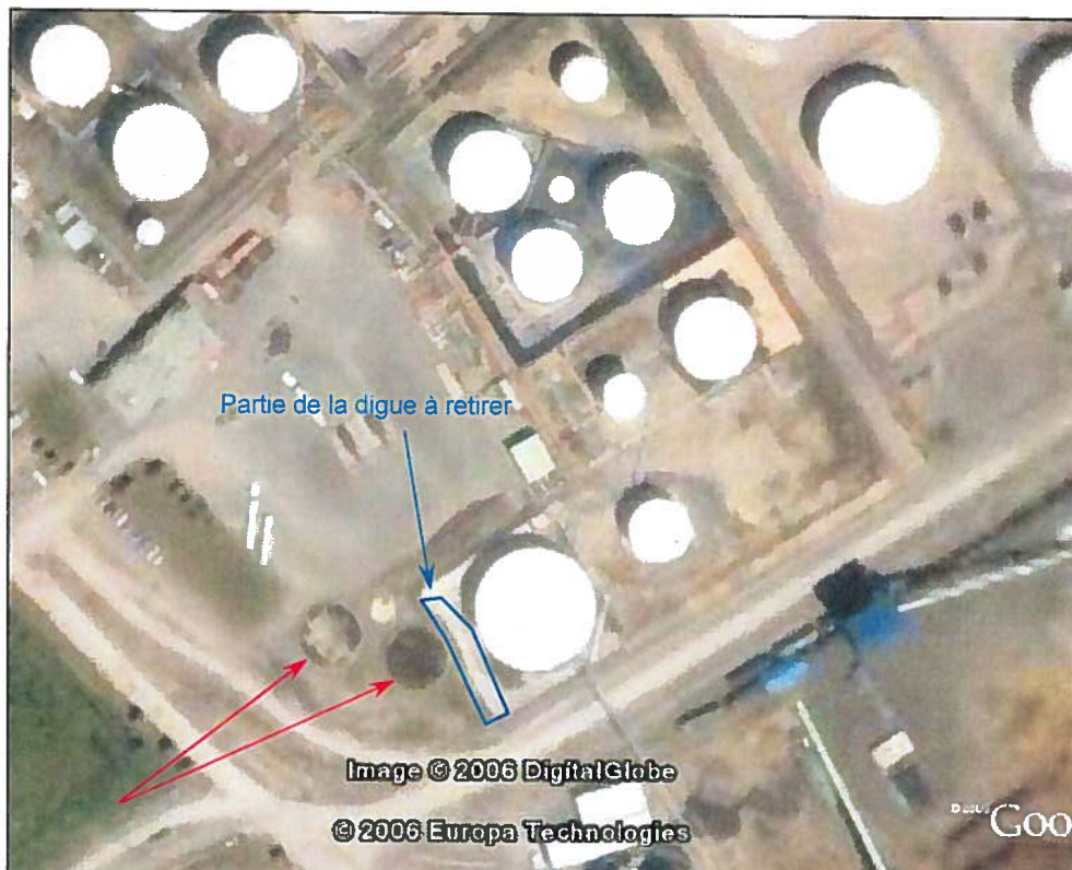
Photo 1. Bases de béton existantes sur lesquelles seront construits les réservoirs 44 et 45
