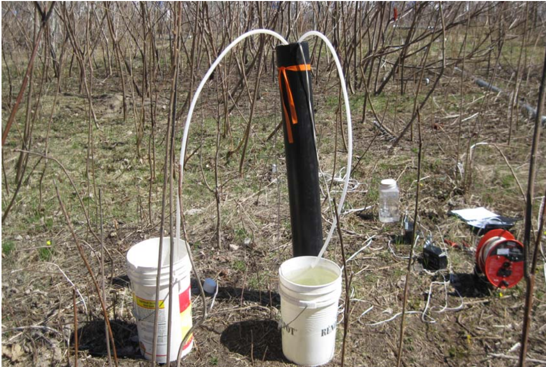
Photo 7 Développement et purge des puits (15 avril 2010) secteur du site de Esso.
