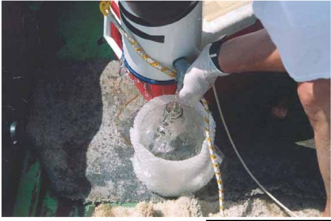
Photo n° 32. Remplissage du contenant en verre de 4L pour les analyses de paramètres organiques (pesticides, etc.) (28 juillet 2004).
