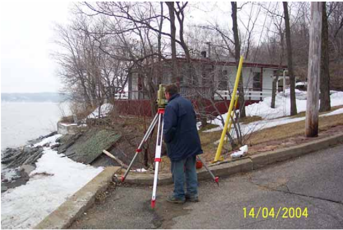
Photo n° 21. Localisation des sites 450 et 617 à l'aide de la station totale (échantillonnage de l'eau de surface).
