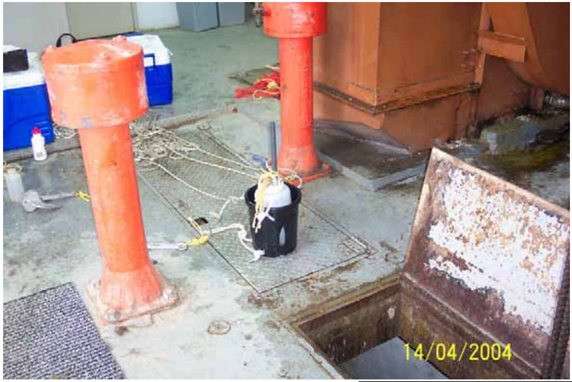
Photo n° 24. Échantillonneur DS-métaux (échantillonnage de l'eau de surface).
