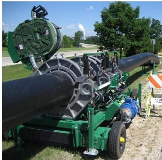
**Figure 2.1 - Machine à fusionner**
