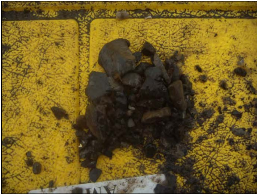
Photographie F4-2 – Fragments de natures diverses : majoritairement shale et calcaire (Prof. : 4.04 à 8.84 m. Récupération : 5%)
