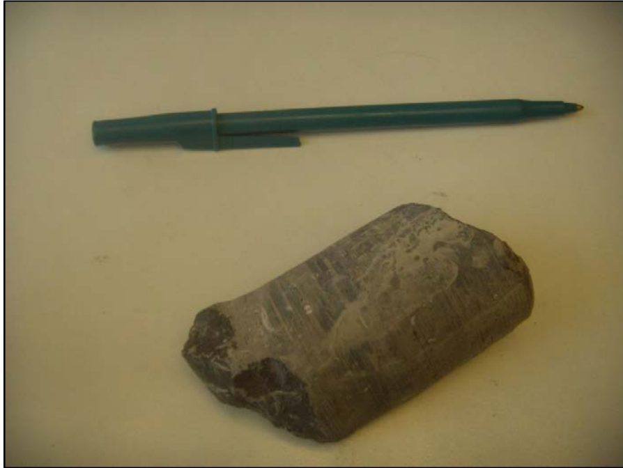
Photographie F4-5 – Bloc de calcaire fossilifère (Prof. : 8.84 à 10.36 m. Récupération : 60%)
