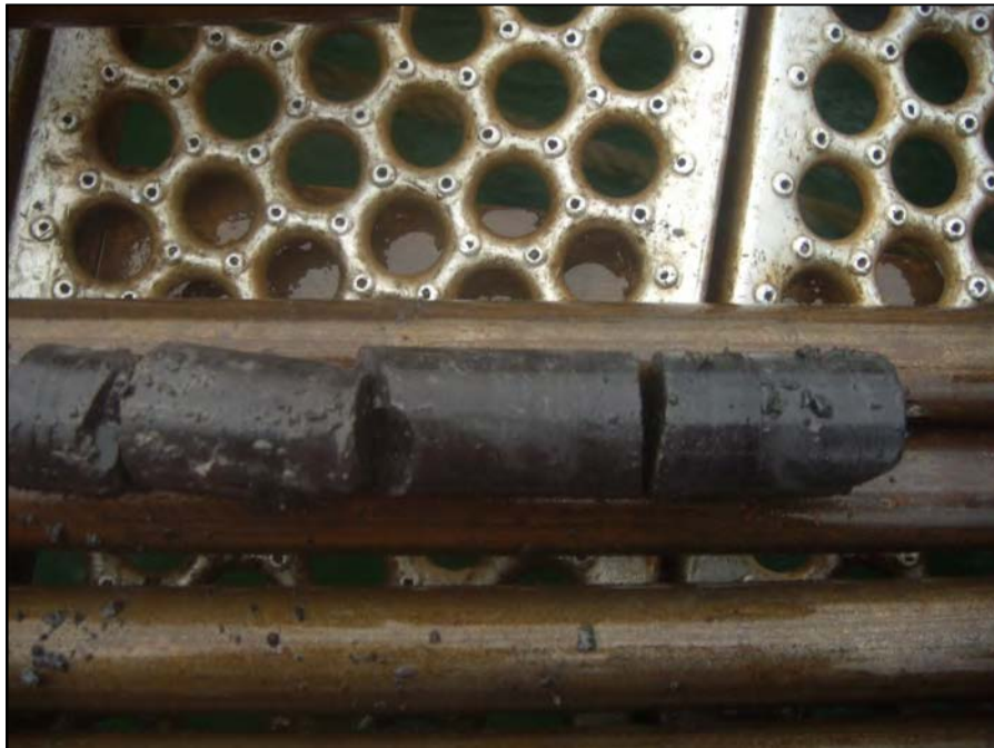
Photographie F5-8 – Bloc de shale (Prof. : 10.57 à 11.09 m. Récupération : 100%)
