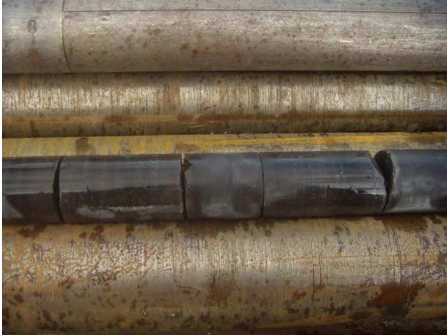
Photographie F2-5 – Roc (shale gris foncé) (Prof. : 8.38 à 9.68 m. Récupération : 80%)
