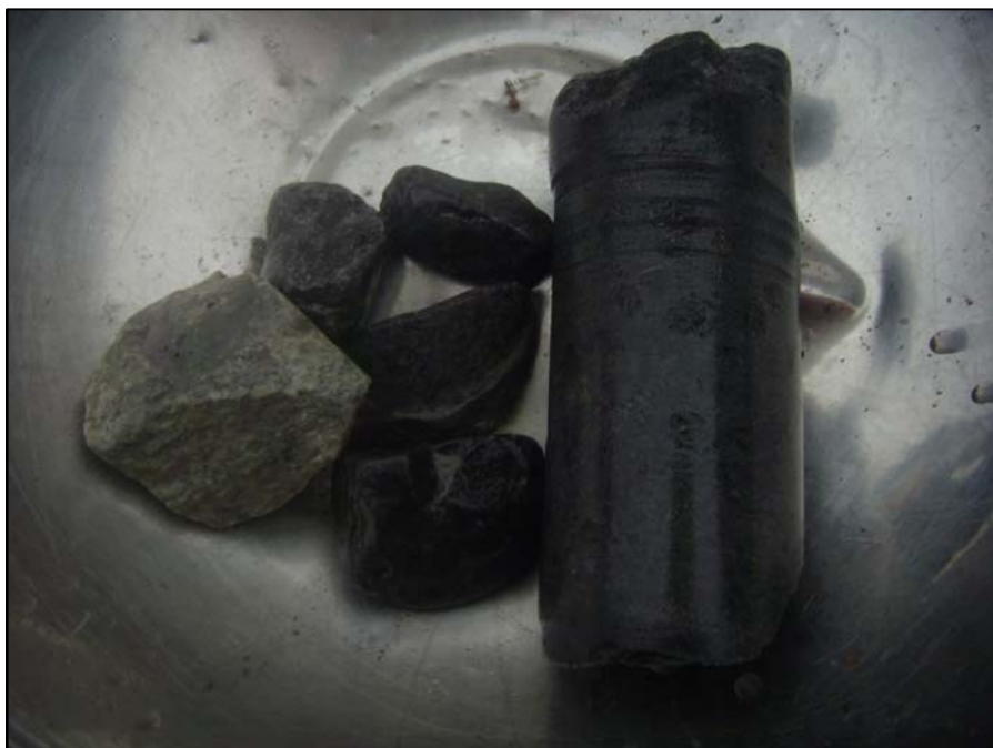
Photographie F2-2 – Blocs et fragments de roche de nature variable (Prof. : 5.03 à 8.38 m. Récupération : 20%)
