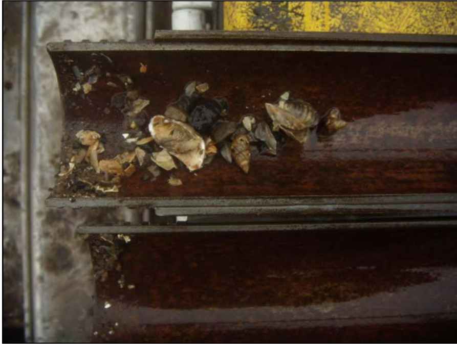
Photographie F4-1 – Récupération de surface : Débris de coquillages et quelques graviers (Prof. : 4.04 m. Récupération : 100%)
