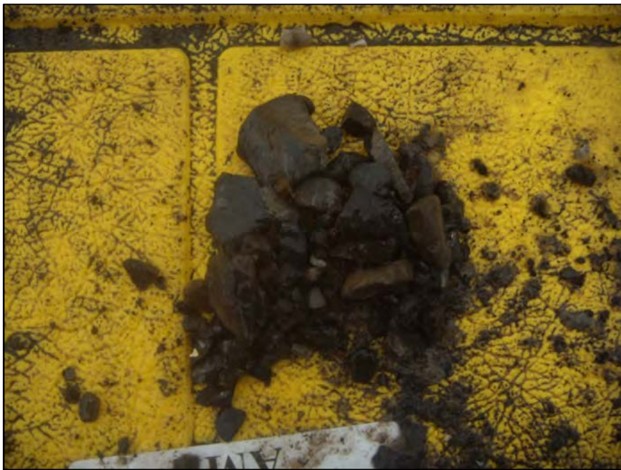
Photographie F4-2 – Fragments de roches de diverses natures : majoritairement shale et calcaire (Prof. : 4.04 à 8.84 m. Récupération : 5%)
