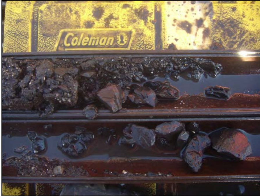
Photographie F3-3 – Fragments de calcaire gris et de shale avec présence d'un peu de sable grossier gris à beige (Prof. : 6.35 à 7.04 m. Récupération : 40%)
