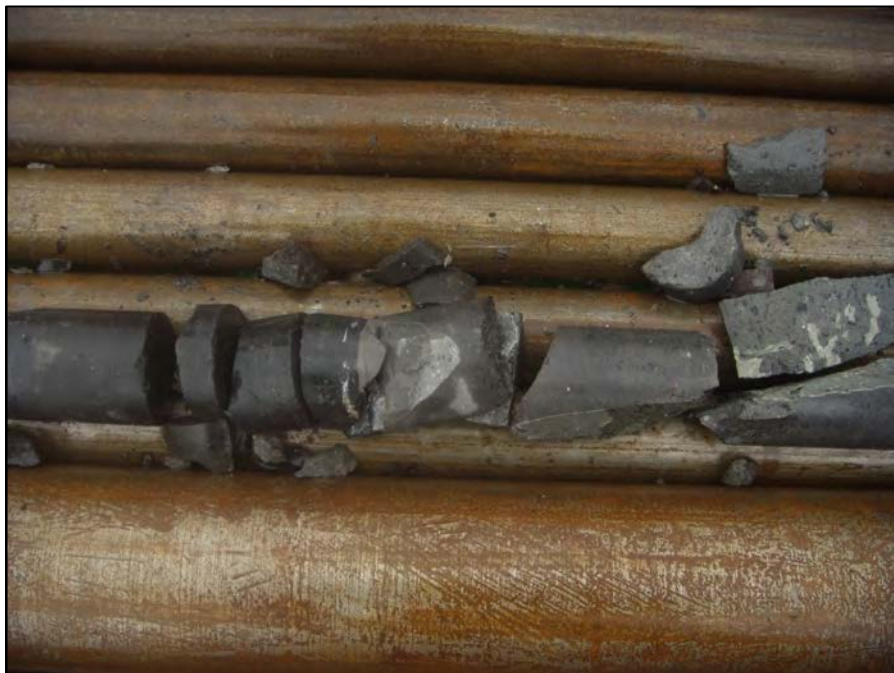
Photographie F5-6 – Bloc mêlant shale, calcaire et roche ignée (Prof. : 10.57 à 12.09 m. Récupération : 100%)
