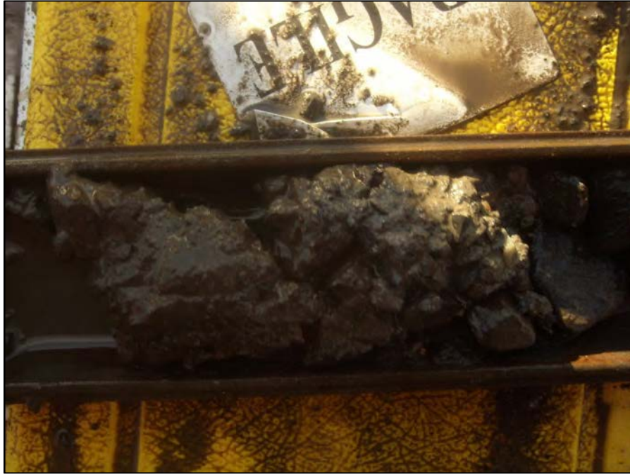
Photographie F3-1 – Sable silteux et fragments de roche (Prof. : 5.13 à 5.74 m. Récupération : 20%)
