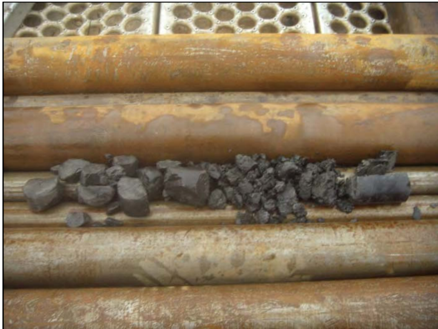
Photographie F2-4 – Blocs et fragments de shale gris (Prof. : 5.03 à 8.38 m. Récupération : 20%)
