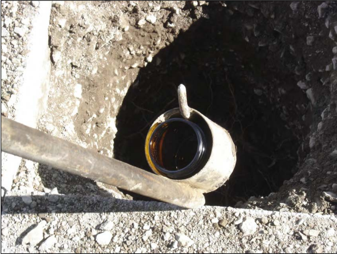
Photo 5 – Système d'échantillonnage des sols en paroi à l'aide d'une perche
