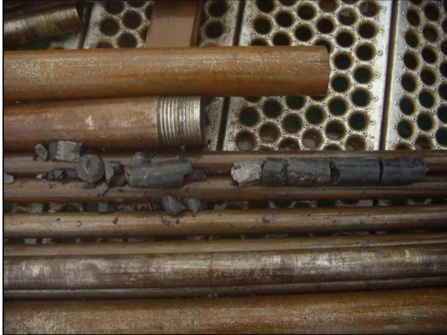
Photographie F5-7 – Bloc mêlant roche ignée et calcaire (Prof. : 10.57 à 11.09 m. Récupération : 100%)
