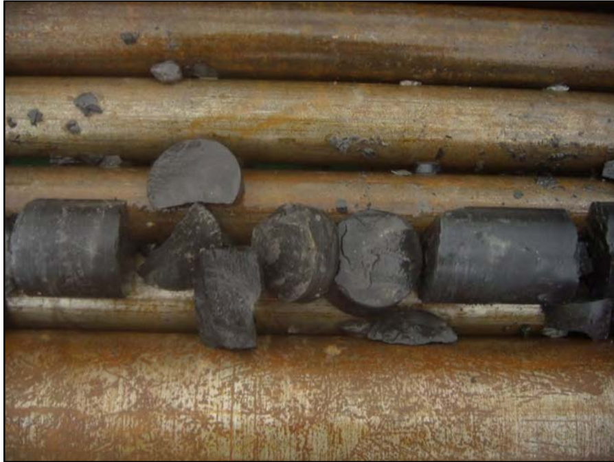
Photographie F5-5 – Bloc calcaire (Prof. : 10.57 à 12.09 m. Récupération : 100%)
