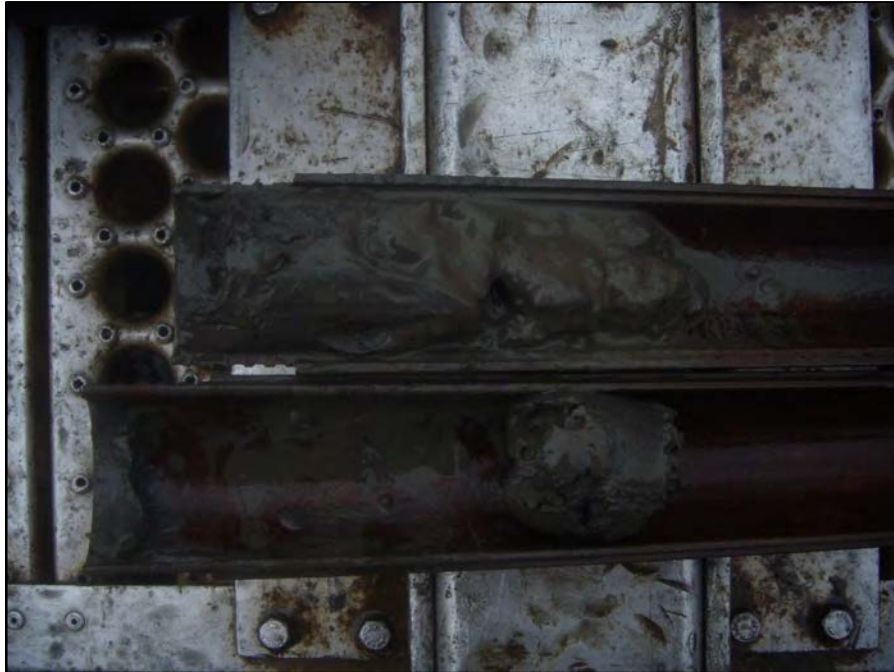
Photographie F1-1 –Sédiment de surface : silt argileux, lâche et humide (Prof. : 4.17 à 4.88 m. Récupération : 25%)
