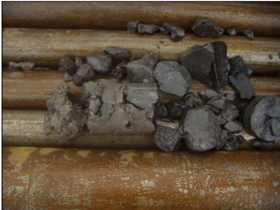
Photographie F5-4 – Fragments de nature variable dans matrice silto-argileuse (Prof. : 10.27 à 10.57 m. Récupération : 50%)
