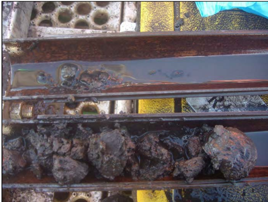
Photographie F3-4 – Fragments de nature variable dans matrice silteuse (Prof. : 6.35 à 7.04 m. Récupération : 40%)
