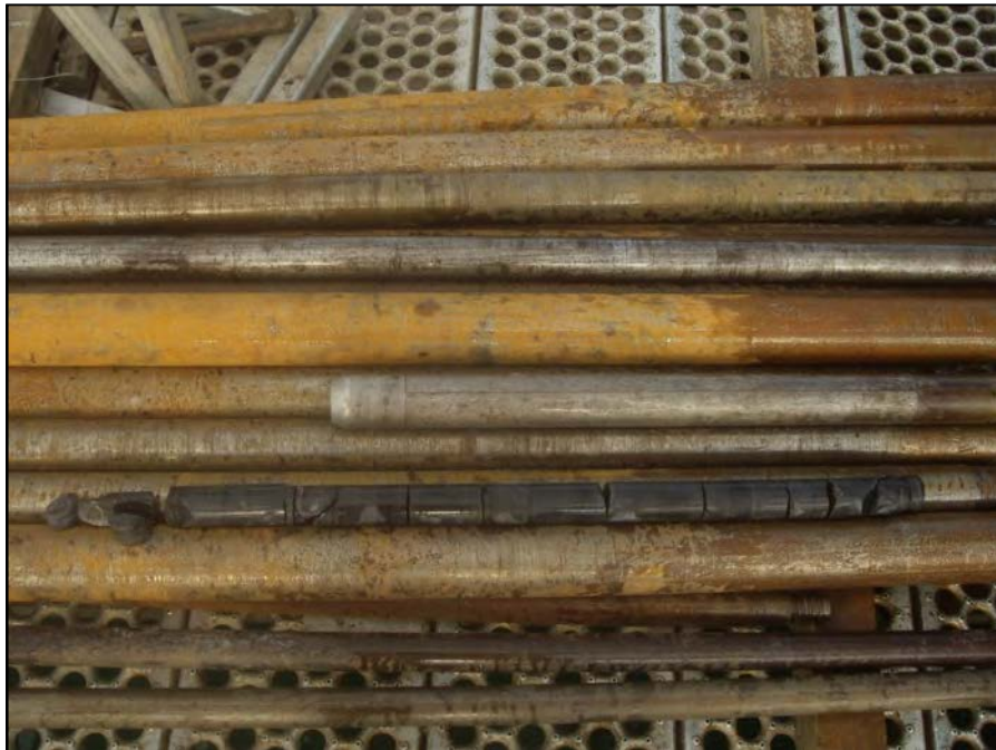
Photographie F3-6 – Roc (shale gris foncé) (Prof. : 7.04 à 8.26 m. Récupération : 100%)
