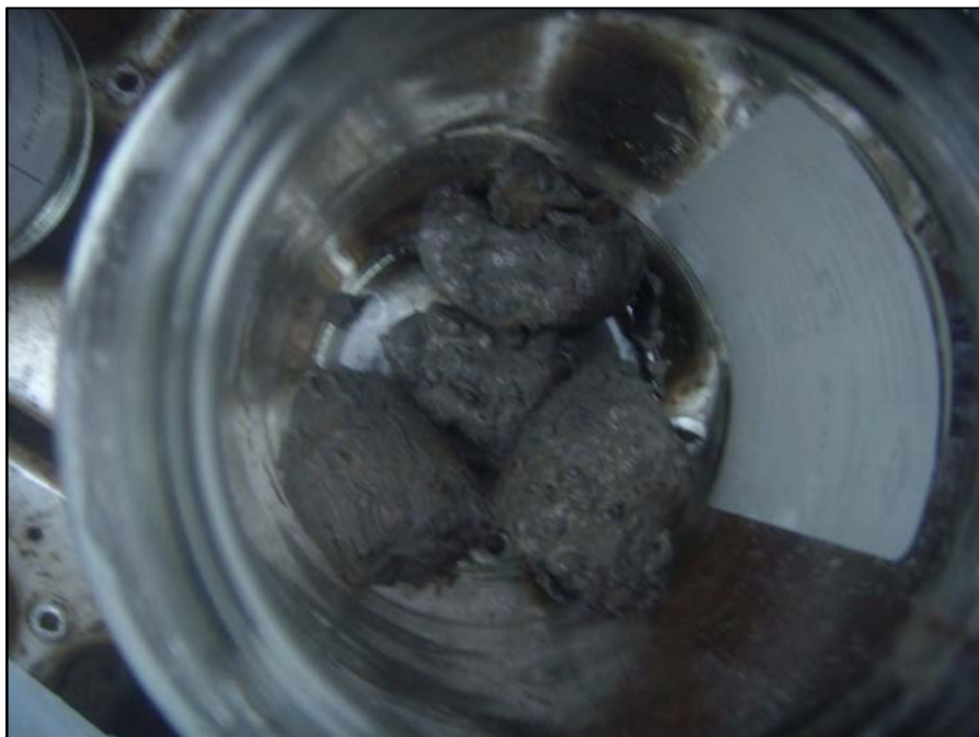
Photographie F2-1 – Matrice de silt gris avec graviers (Prof. : 5.03 à 8.38 m. Récupération : 5%)
