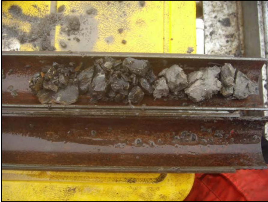
Photographie F5-1 – Fragments de nature variable dans matrice silto-argileuse (Prof. : 7.47 à 10.57 m. Récupération : 10%)
