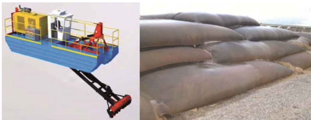
Figure 4-6 Drague aspiratrice et géotubes contenant les sédiments aspirés en rives
