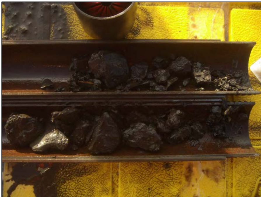
Photographie F3-2 – Fragments de calcaire gris et de shale (Prof. : 5.74 à 6.35 m. Récupération : 20%)
