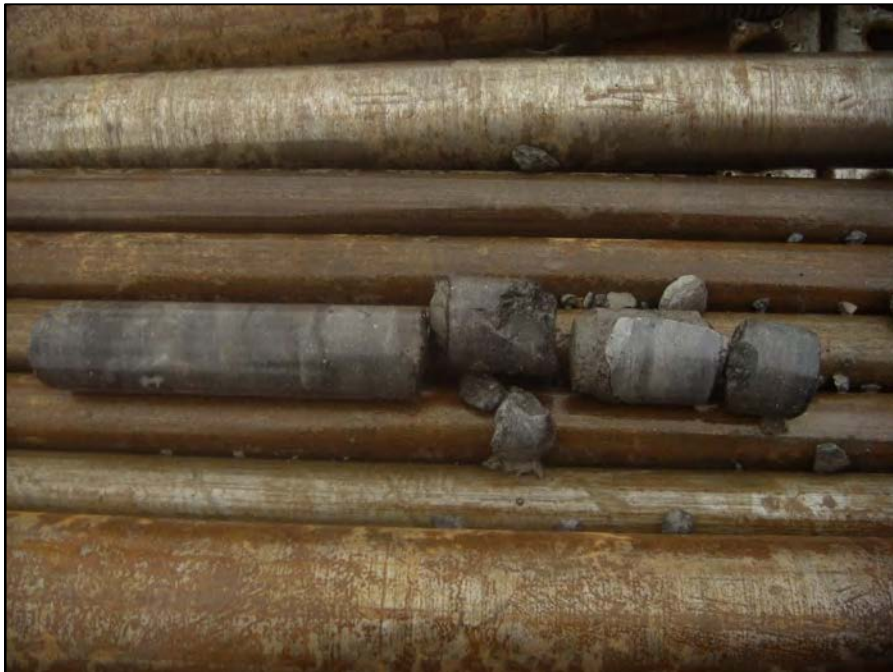
Photographie F5-2 – Blocs de shale et calcaire avec matrice silto-argileuse (Prof. : 7.47 à 10.57 m. Récupération : 40%)
