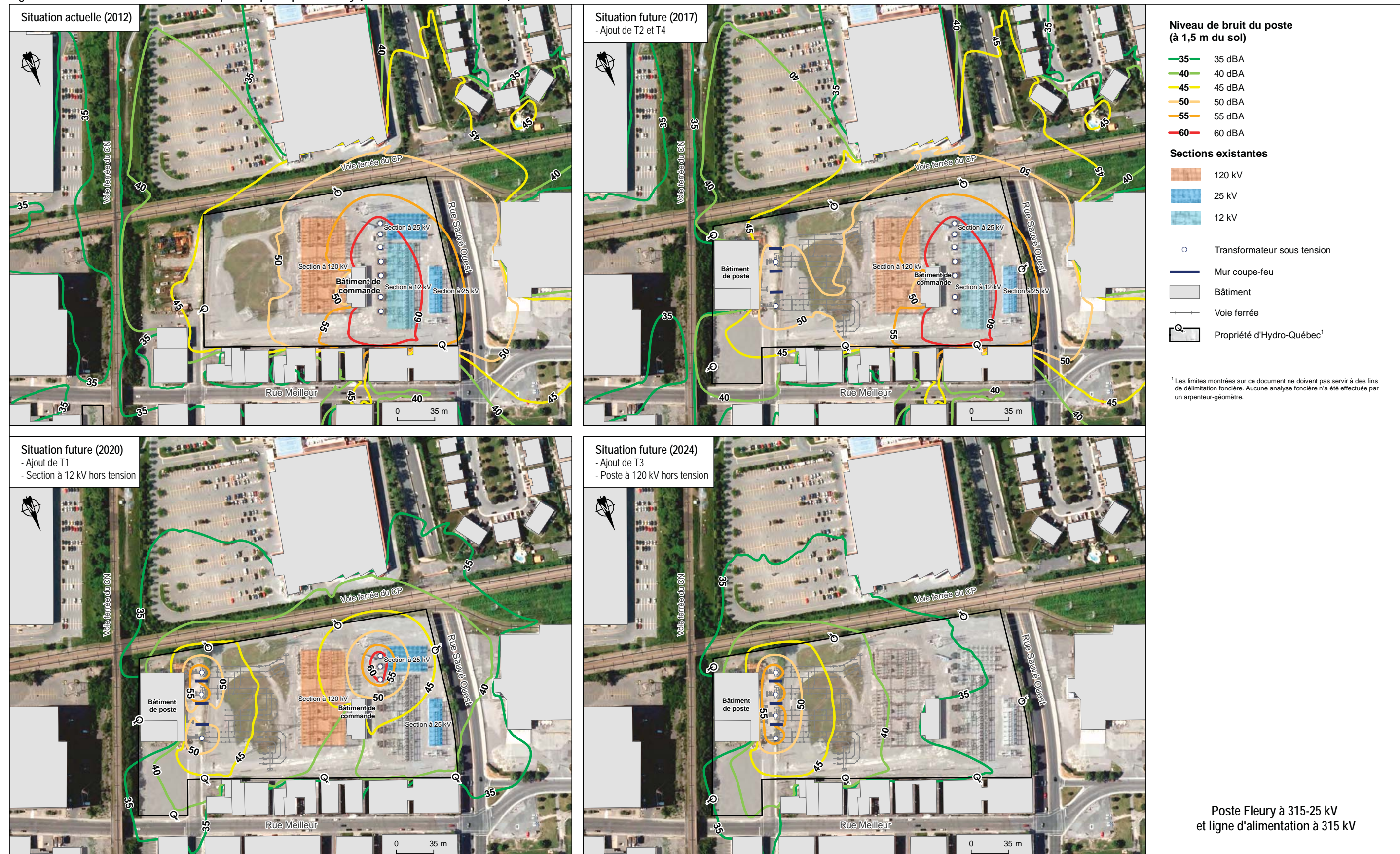
Figure 7-1 : Estimation du niveau sonore produit par le poste Fleury (situations actuelle et futures)
