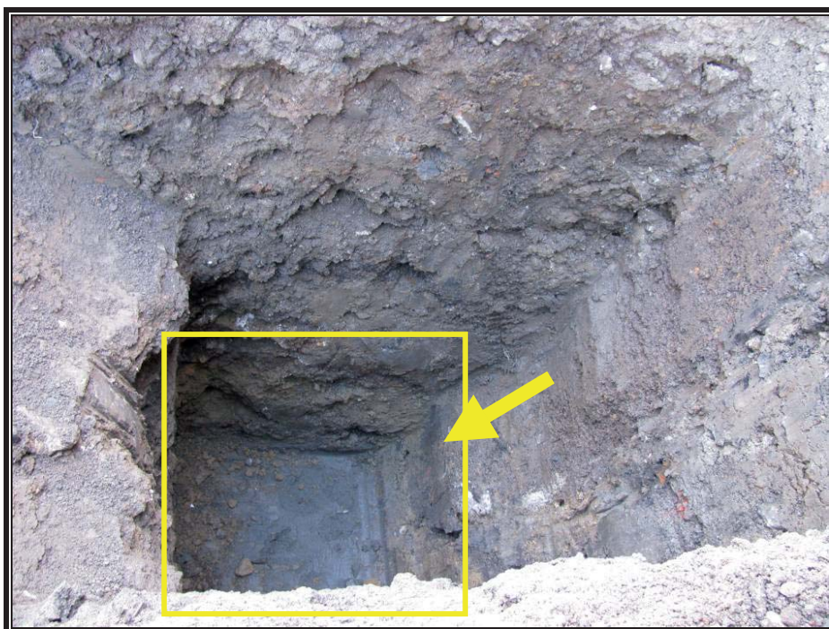
Photo 10 : Vue de la tranchée TE-08-18 avec indices organoleptiques de contamination en profondeur (prise de vue ouest, 12 novembre 2008).
