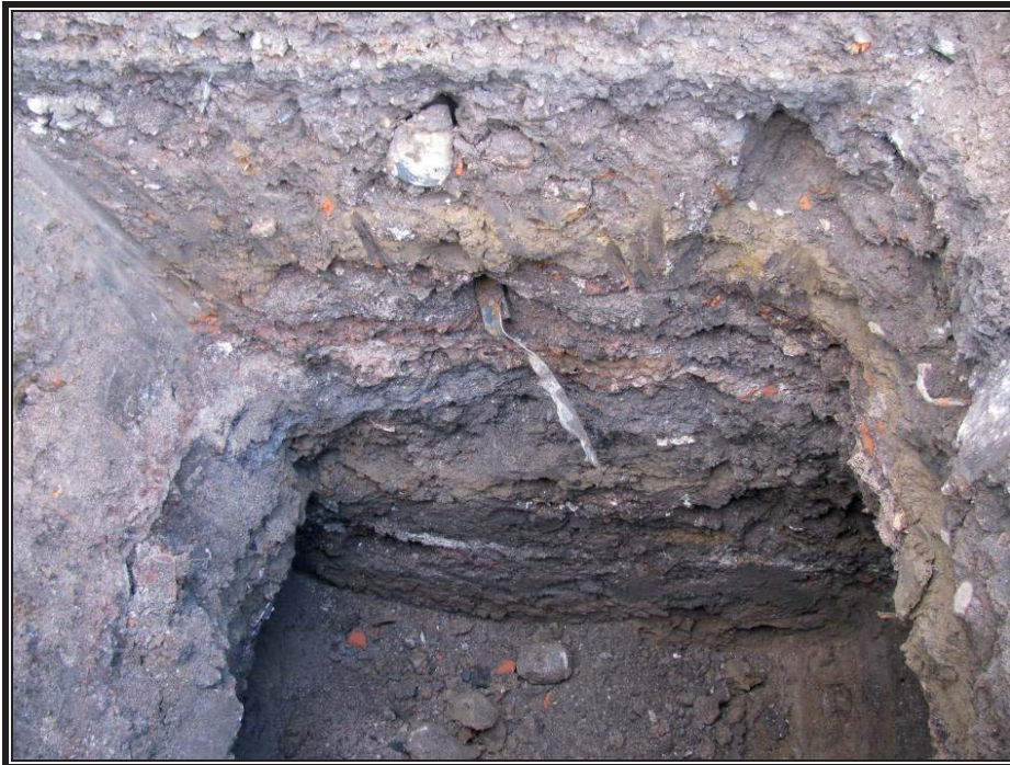
Photo 11 : Vue de la tranchée TE-08-19 présentant différents horizons de remblai avec matières résiduelles (prise de vue sud, 12 novembre 2008).
