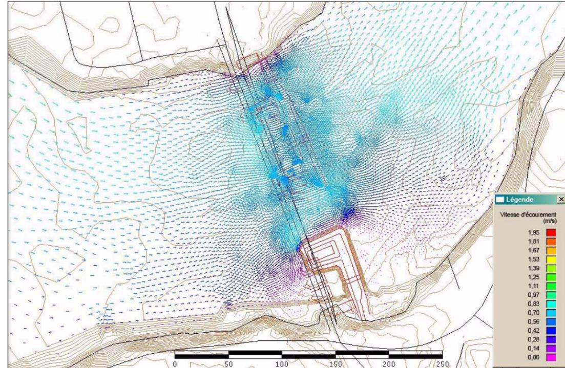
Vitesse d'écoulement – débit de 511 m<sup>3</sup>/s
