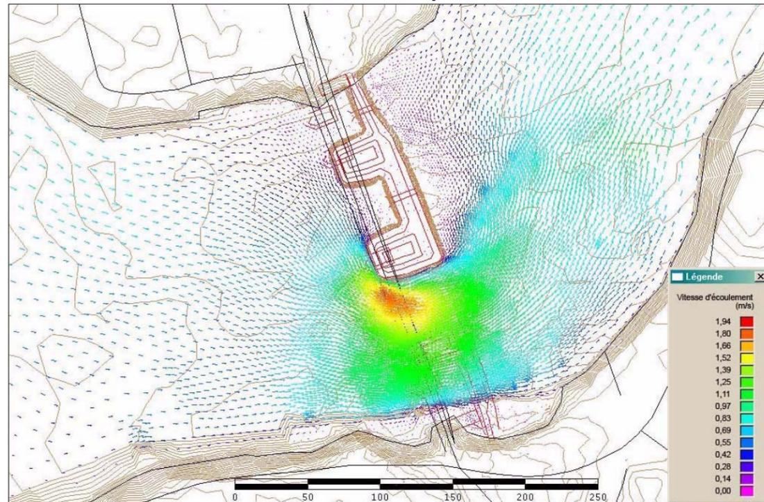
Vitesse d'écoulement – débit de 511 m<sup>3</sup>/s
