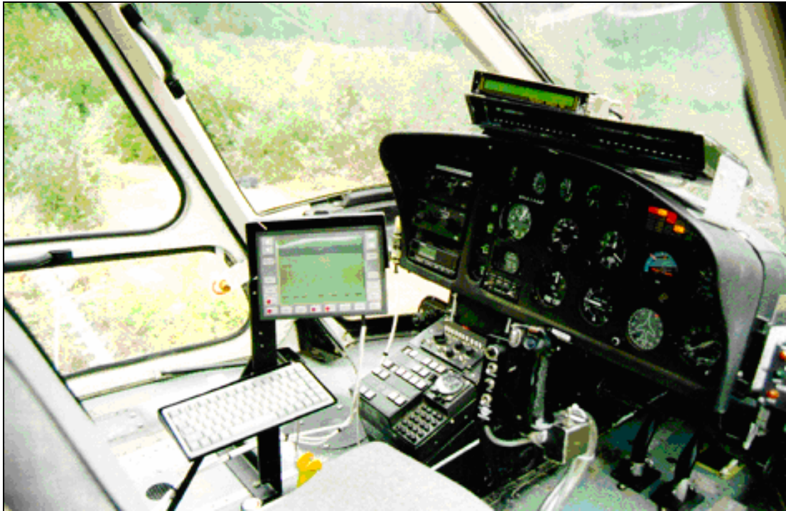
Photo 14-2 : Vue du module installé dans l'hélicoptère d'arrosage
