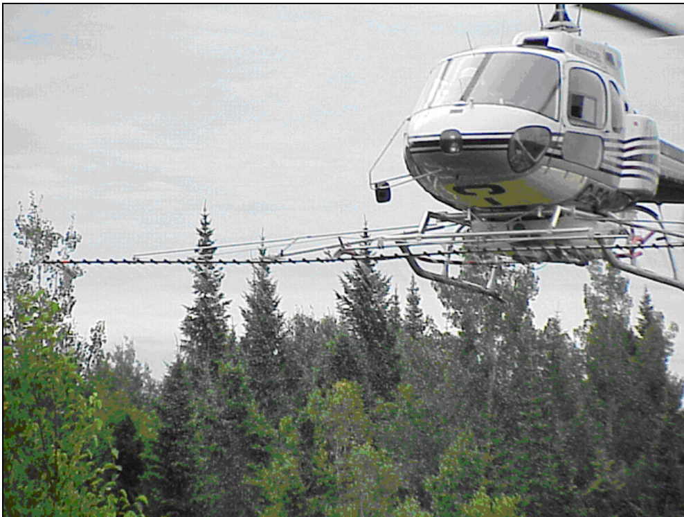
Photo 10-2 : Buses du dispositif de pulvérisation de l'hélicoptère
