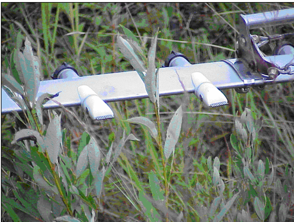
Photo 10-2 : Buses du dispositif de pulvérisation de l'hélicoptère
