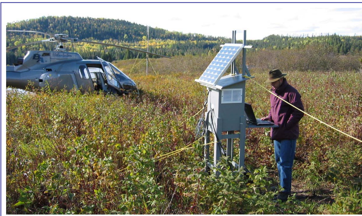
PHOTO 6 — Téléchargement des données à la station télémétrique de la rivière au Serpent
