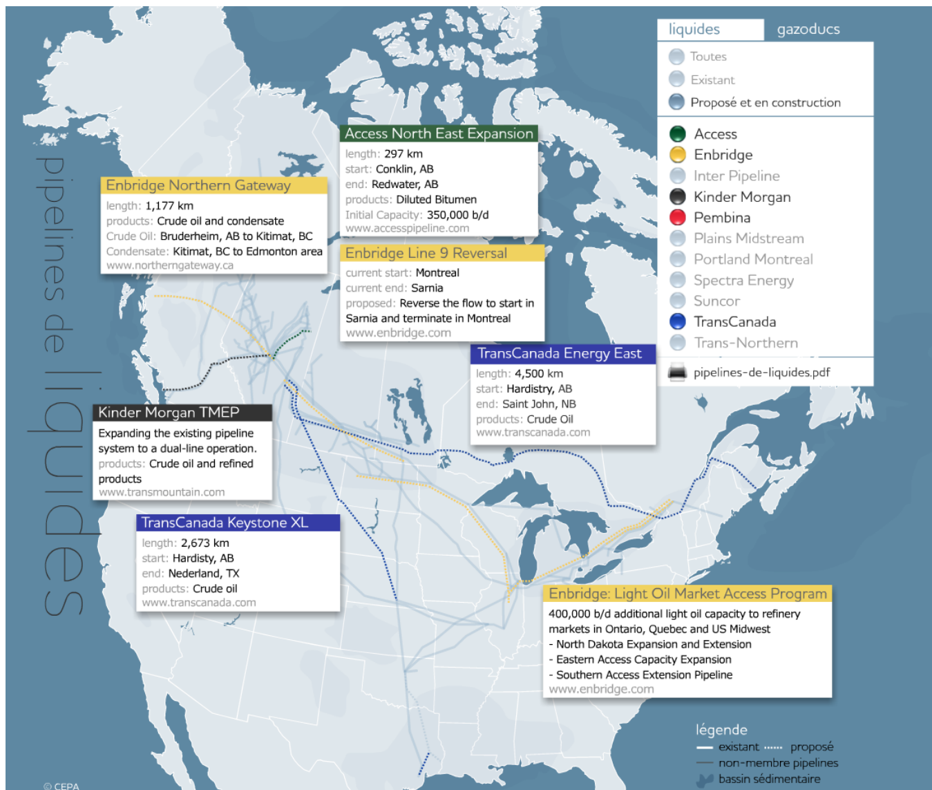
Figure 5-7 : Les oléoducs en cours d'évaluation ou en cours de construction
