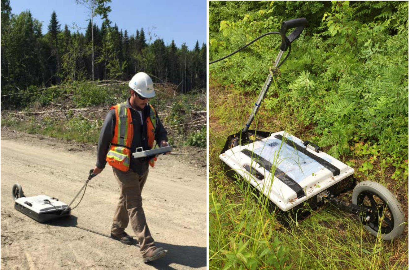
Image 1 : Géoradar en fonction (photo de gauche); Démonstration de l'imperméabilité de l'équipement pour des conditions rigoureuses (photo de droite)
