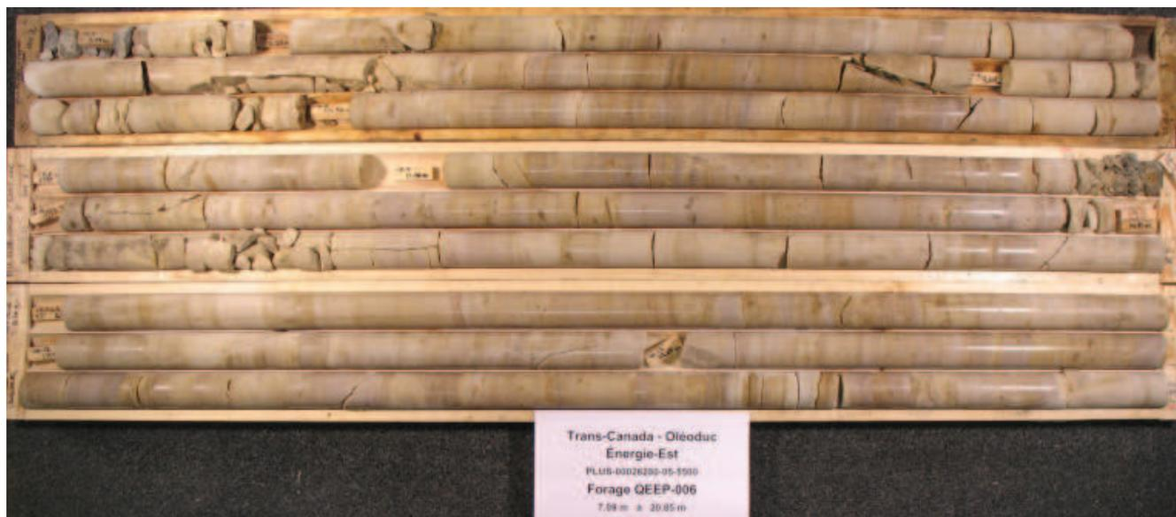
Photo 1. Forage QEEP-006: boîtes 1 à 3 / 5 (7,09 m à 20,85 m)
