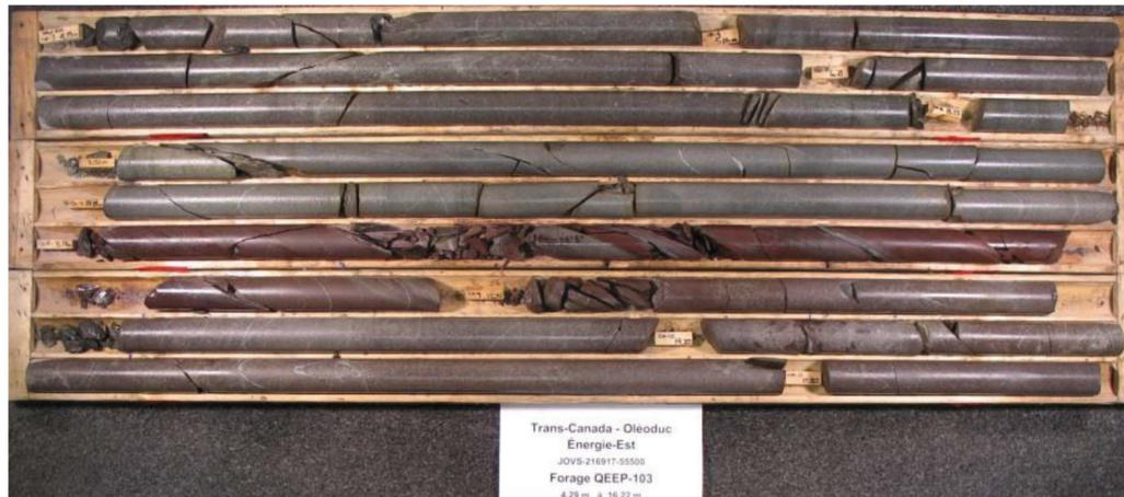
Photo 1. Forage QEEP-103: boîtes 1 à 3 / 9 (4,29 m à 16,22 m)
