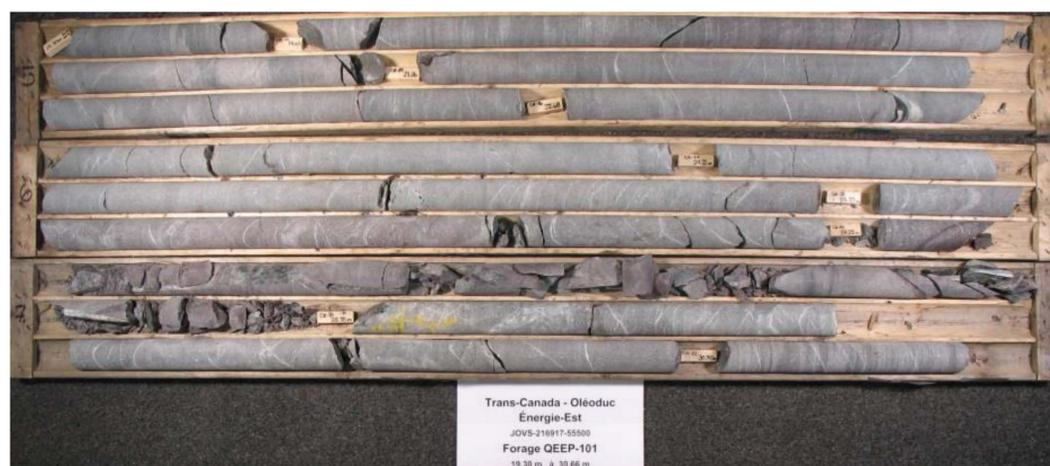
Photo 2. Forage QEEP-101: boîtes 5 à 7 / 10 (19,30 m à 30,66 m)
