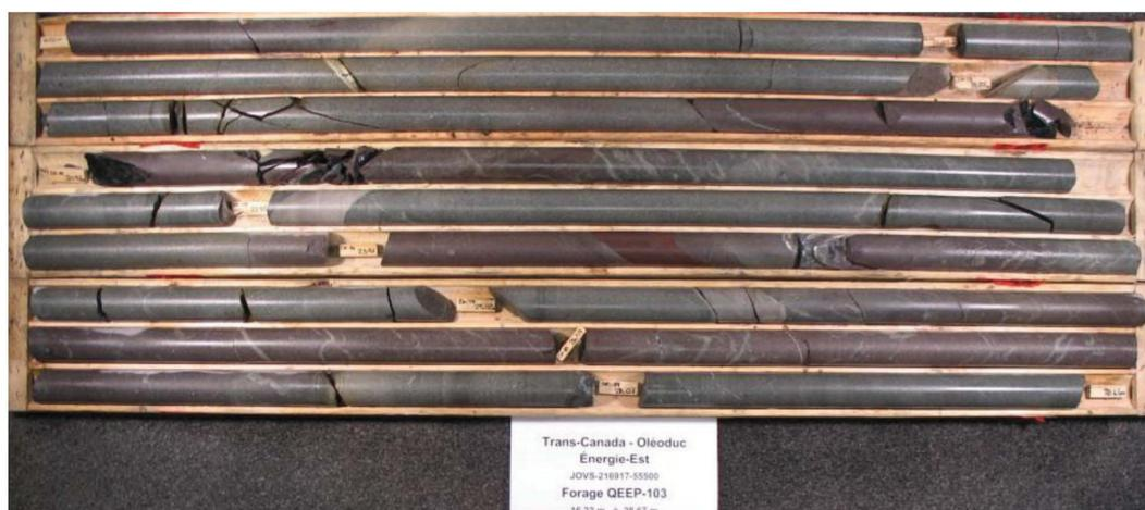
Photo 2. Forage QEEP-103: boîtes 4 à 6 / 9 (16,22 m à 28,67 m)
