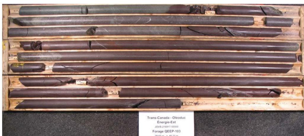
Photo 3. Forage QEEP-103: boîtes 7 à 9 / 9 (28,67 m à 40,23 m)
