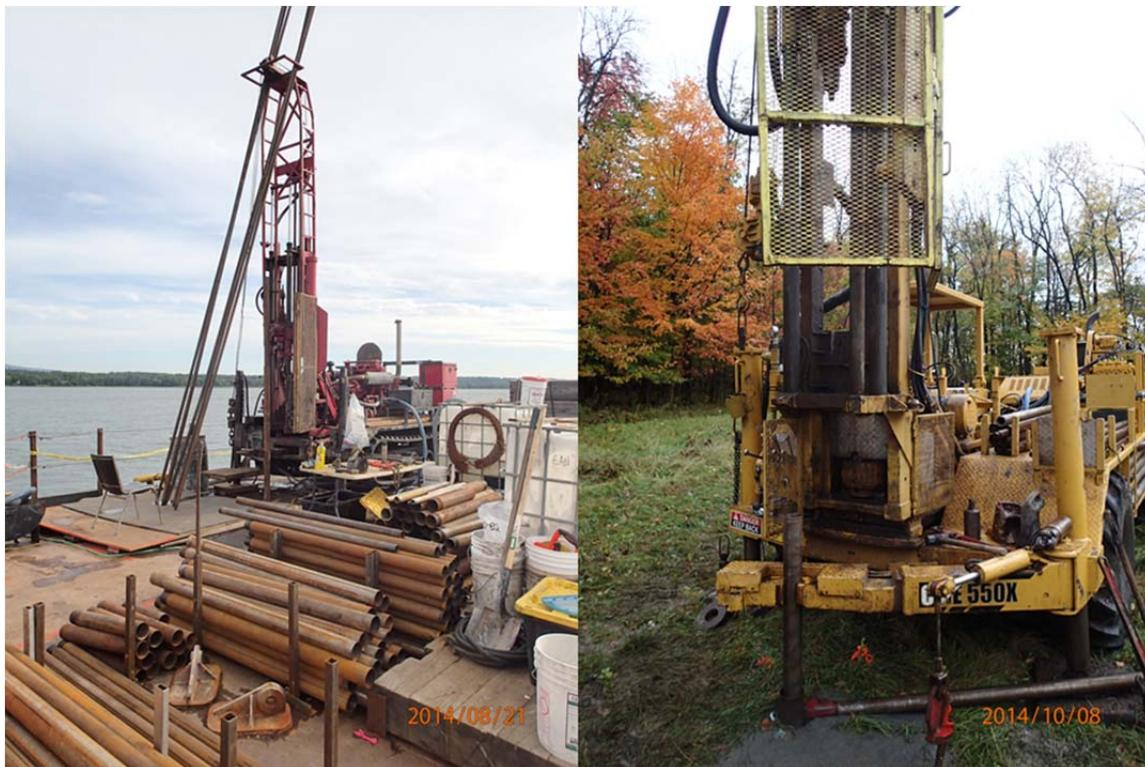
**FIGURE 3-10 – FOREUSE SUR BARGE (À GAUCHE) ET FOREUSE TERRESTRE (À DROITE) UTILISÉE LORS DE LA CAMPAGNE D’INVESTIGATION 2014.**
