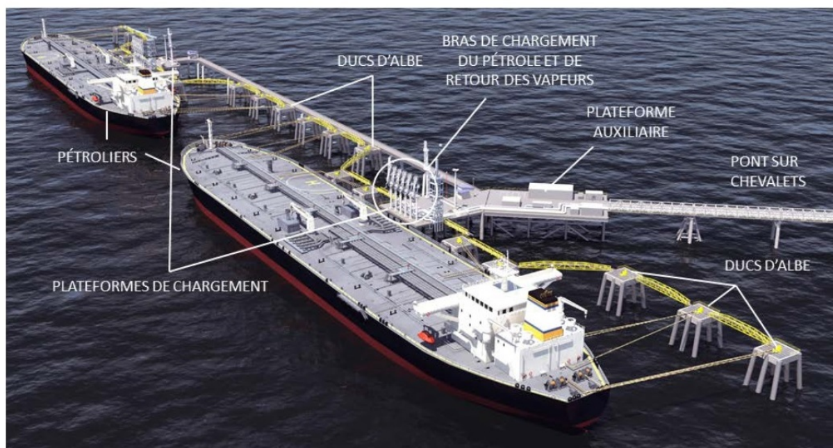
Figure 3-4 : Terminal maritime mis à jour Canaport d'Énergie Est – Schéma conceptuel des plateformes en mer
