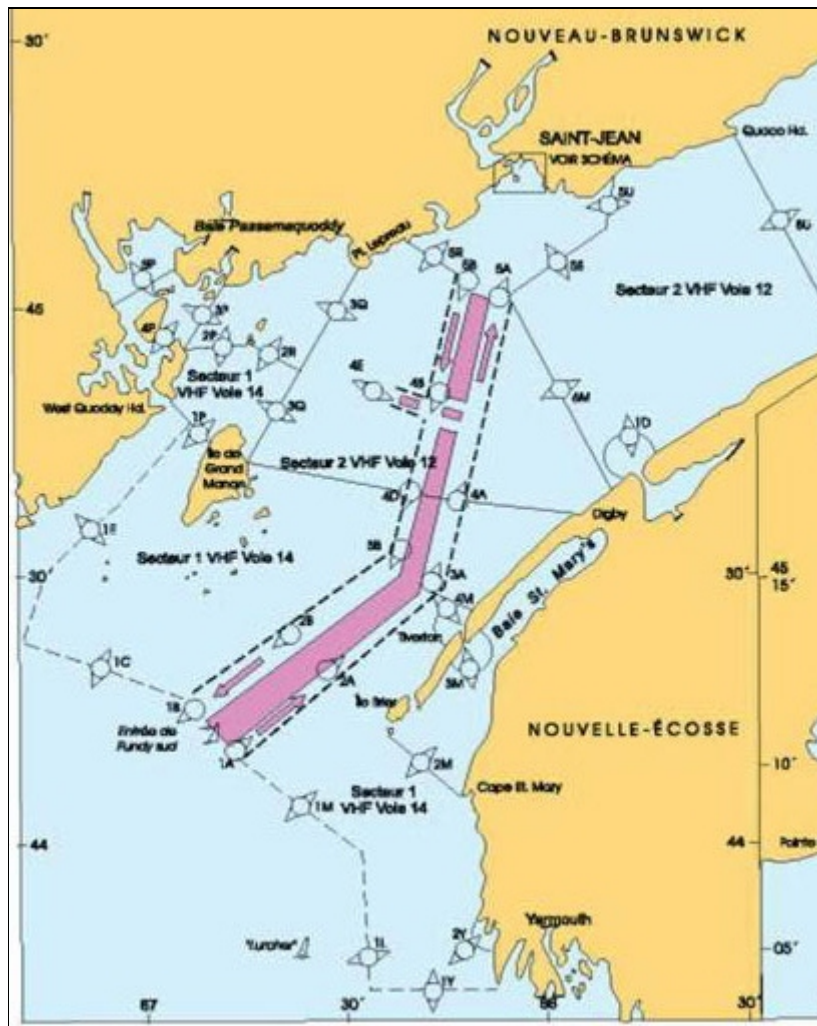
Figure 5-3 : Limites relatives aux Services de communications et de trafic maritimes – Trafic dans la baie de Fundy
