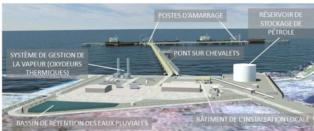
**Figure 7-2 : Terminal maritime de Cacouna – Schéma conceptuel de la zone intertidale**
