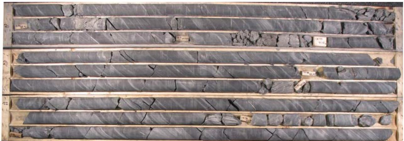
Photo 6. Forage QEEP-070: boîtes 20 à 22 / 25 (86,44 m à 99,85 m)
