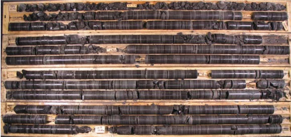
Photo 1. Forage QEEP-039: boîtes 1 à 4 / 13 (8,74 m à 26,26 m)
