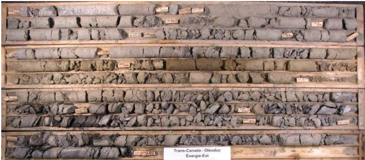
Photo 1. Forage QEEP-03: boîtes 1 à 4 / 4 (11,61 m à 29,90 m)
