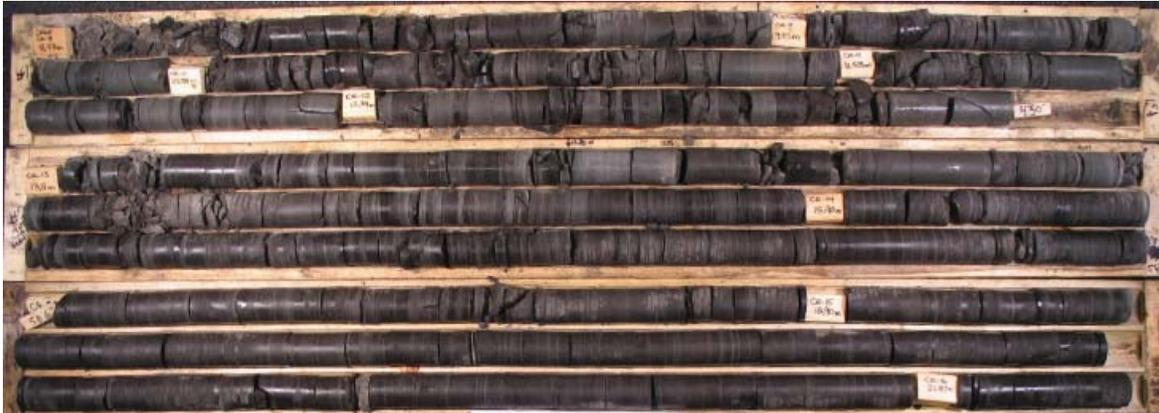
Photo 1. Forage QEEP-038: boîtes 1 à 3 / 6 (8,97 m à 22,11 m)
