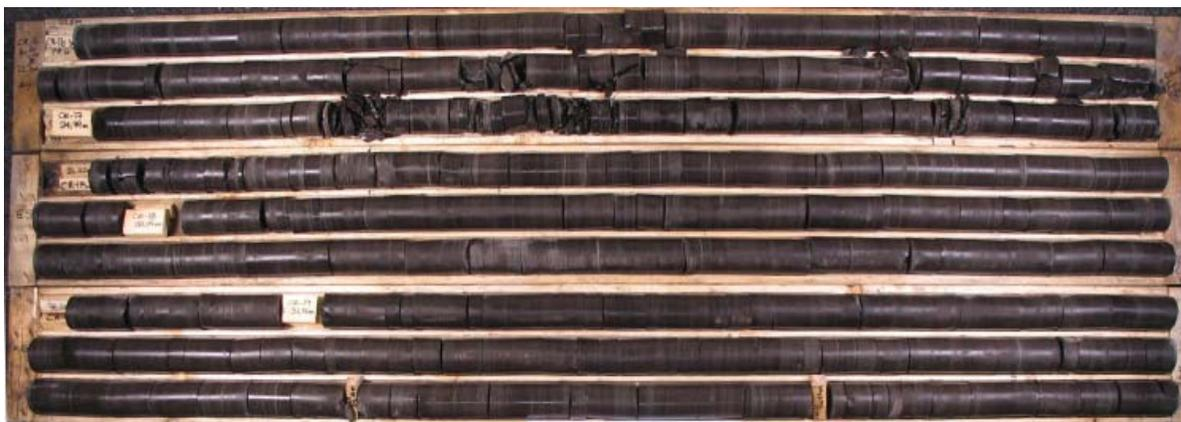
Photo 2. Forage QEEP-038: boîtes 4 à 6 / 6 (22,11 m à 35,23 m)
