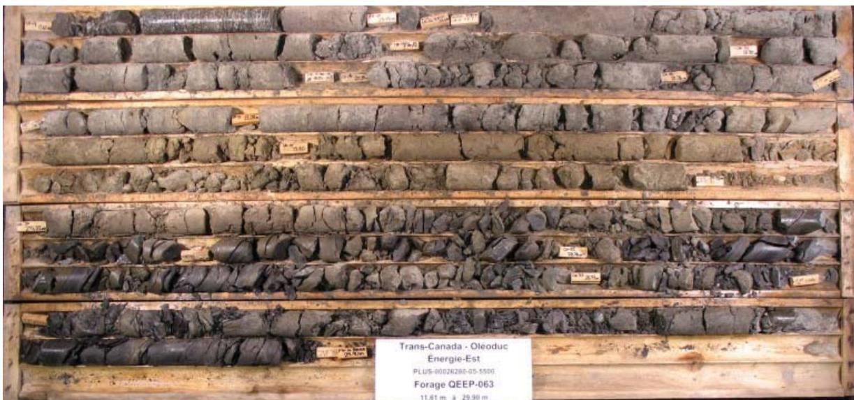
Photo 1. Forage QEEP-03: boîtes 1 à 4 / 4 (11,61 m à 29,90 m)
