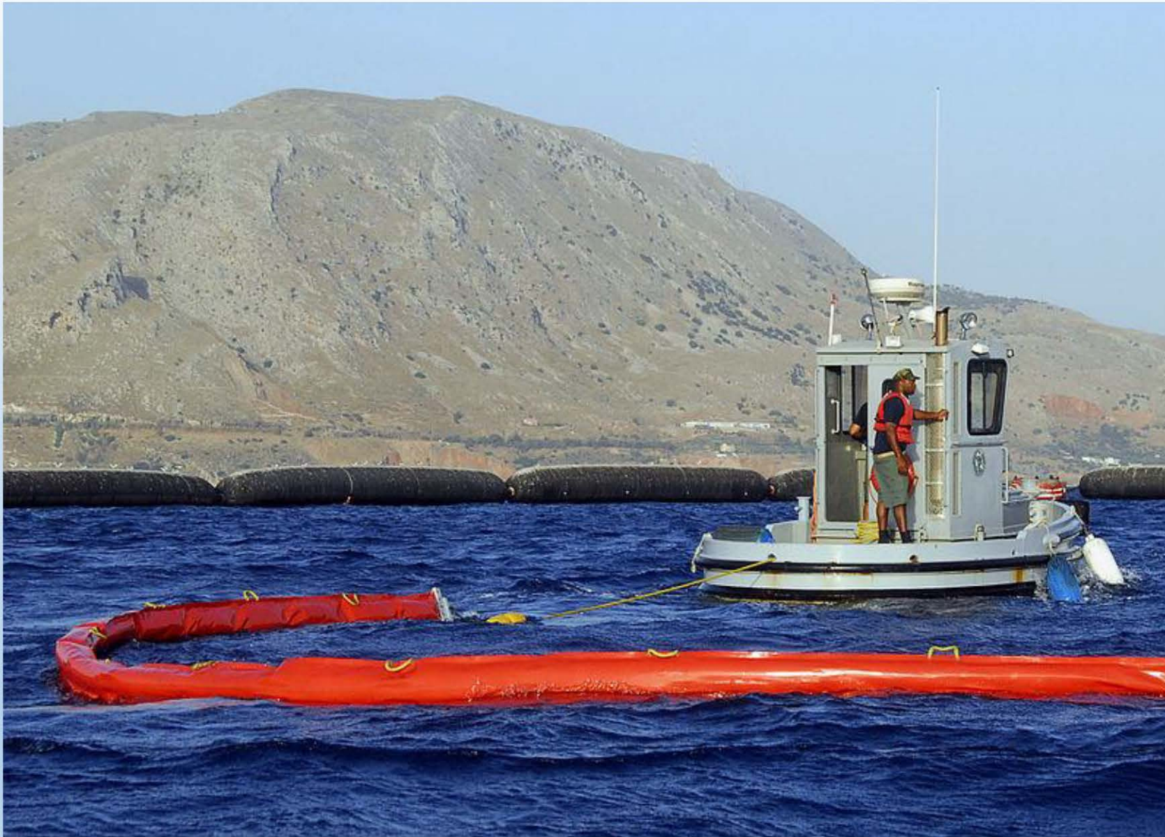
Démonstration d'une technique de récupération dite «harbour buster» par la U.S. Navy https://en.wikipedia.org/wiki/Oil_spill#Largest_oil_spills
