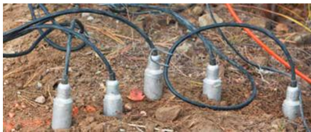
Figure 4. 15. Géophones permettant d'enregistrer les échos réfléchis sous la surface par les ondes sismiques (SWN Ressources Canada, 2012).
