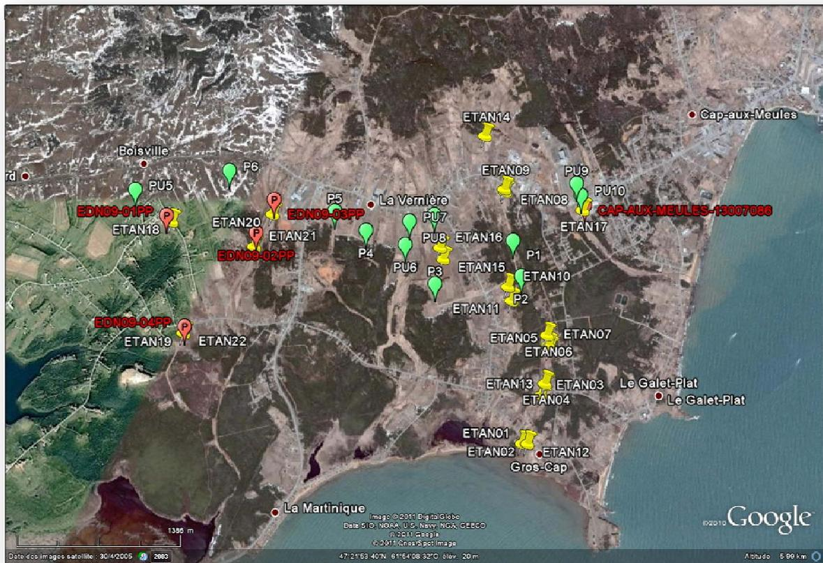
**Figure 6 :** Étang-du-Nord : position des sondages TEM (en jaune) et des puits (en vert). Les nouveaux puits réalisés en 2009 et en attente de certification sont indiquées en rouge.
