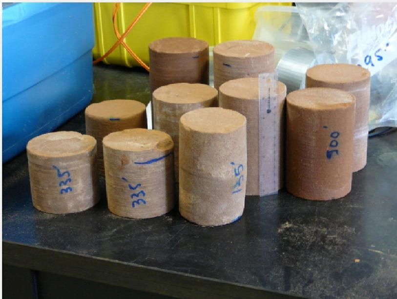
**Figure 24** : carottes de grès rouge (porosité de 15-25%) du forage pétrolier G-003 provenant de diverses profondeurs, sciées et surfacées. La profondeur (en pieds) est indiquée au feutre bleu sur la surface latérale des carottes.
