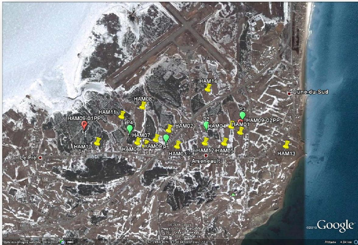
**Figure 7:** Havre-Aux-Maisons : position des sondages TEM (en jaune) et des puits municipaux de production d'eau (en vert). Les puits indiqués en rouge sont les nouveaux puits (2009) en attente de certification.
