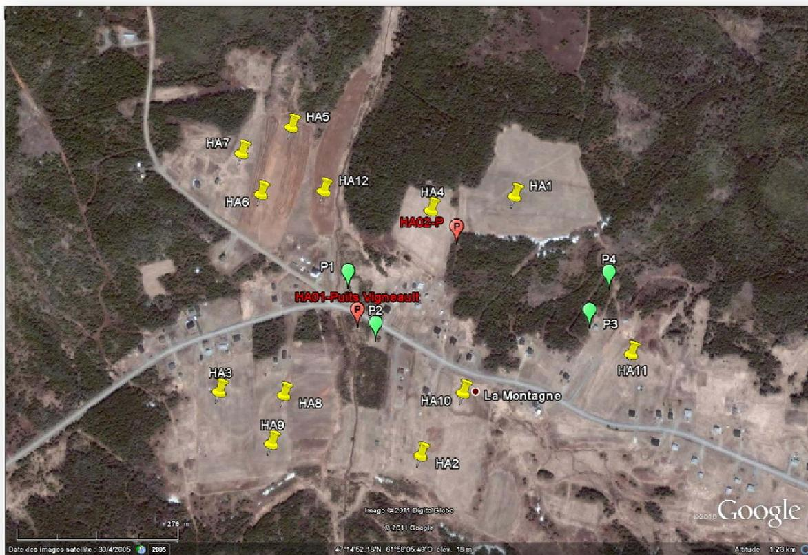
**Figure 4 :** Havre-Aubert : position des sondages TEM (en jaune) et des puits. Les puits Vigneau et Ha002 (en rouge) sont d'anciens puits d'exploration (1966) alors que les puits P1 à P4 (en vert) sont des puits de production d'eau municipale.
