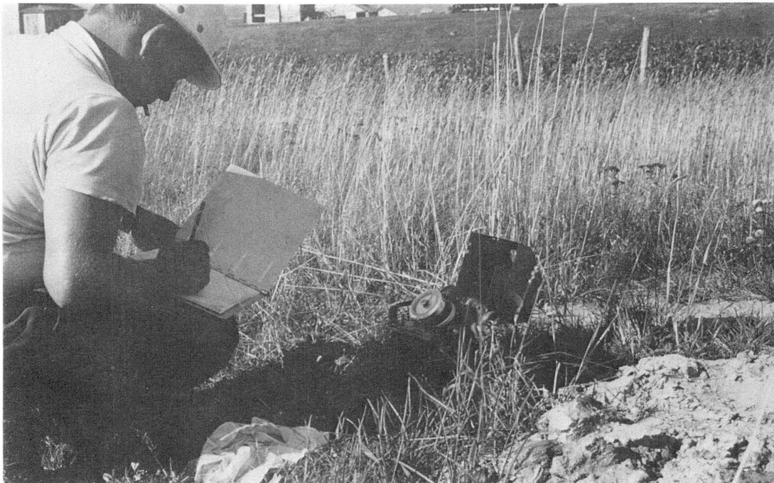
B—Mesure du niveau de l'eau au moyen d'un limnimètre à plongeur
