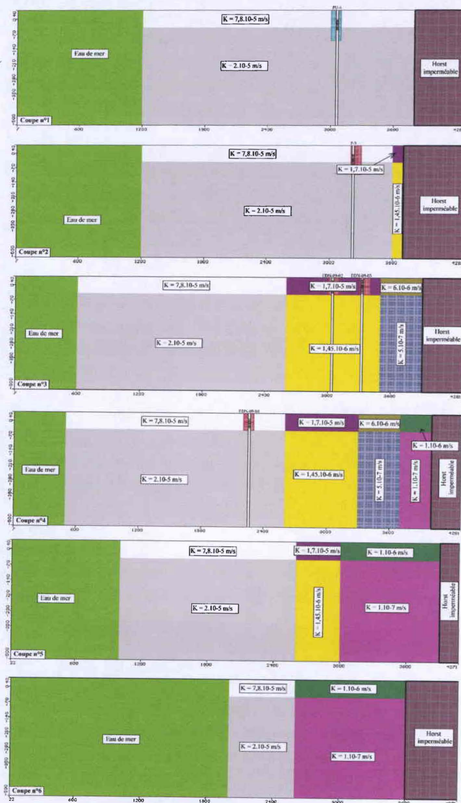
Figure 10 : Coupes N-S du domaine modélisé montrant les différentes perméabilités appliquées
