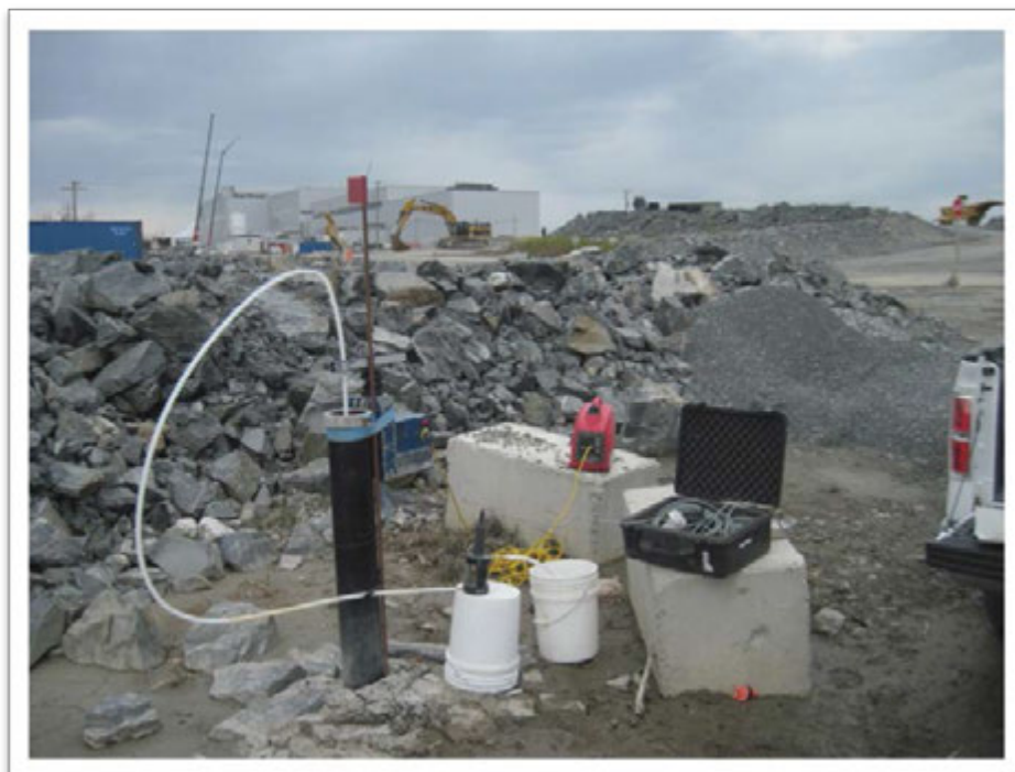
Figure 2: Purge et procédure d'échantillonnage – secteur Halde à stériles
