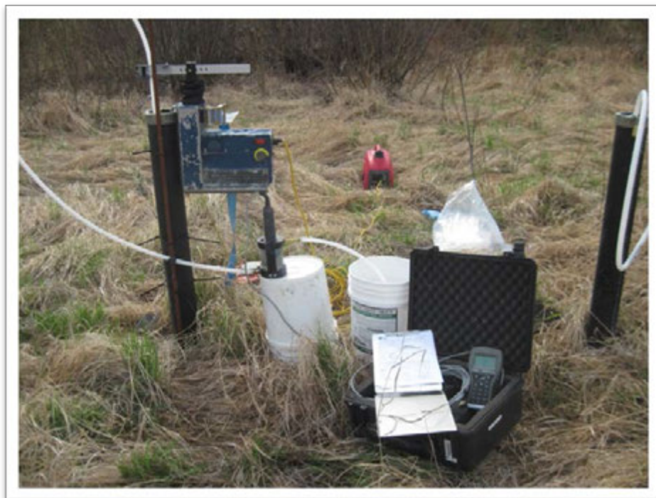
Figure 3: Purge et procédure d'échantillonnage – secteur Bassin sud-est
