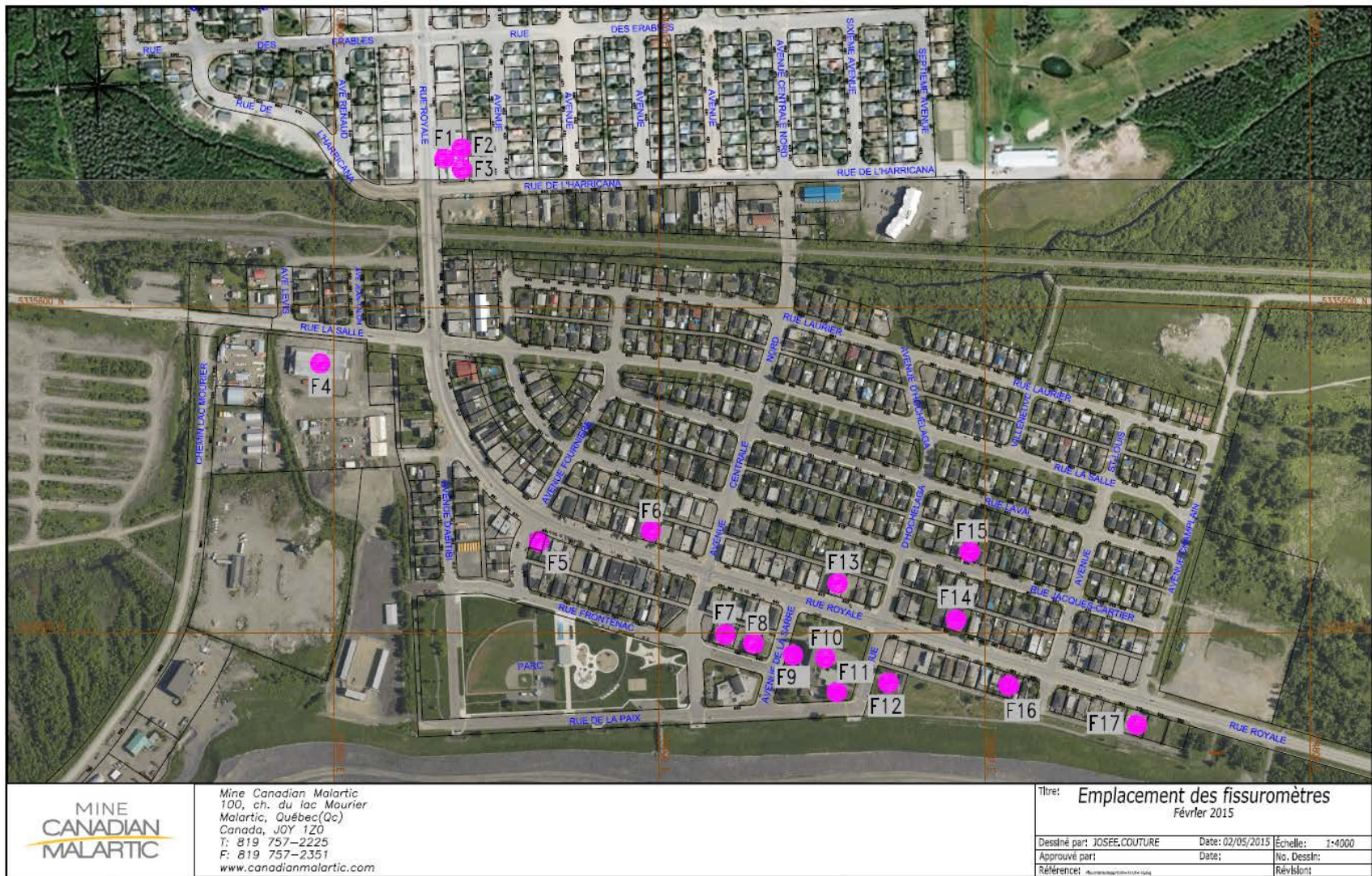
Figure 2 - Emplacement des fissuromètres dans la ville de Malartic (non à l'échelle)
