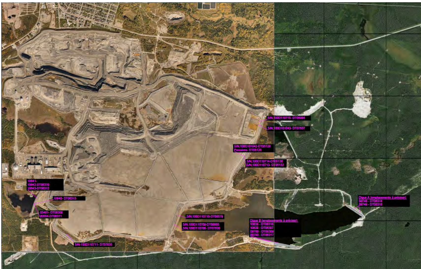
Figure 4 : Emplacement des piézomètres sur le parc à résidus
