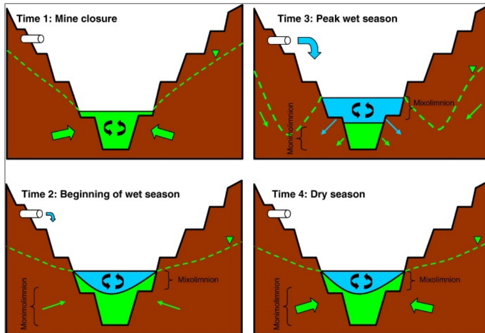
Figure F: Influence de l'apport différentiel en eau de surface et en eau souterraine sur la stratification de la colonne d'eau d'un lac de fosse (extrait de Castendyck et Webster-Brown, 2007).
