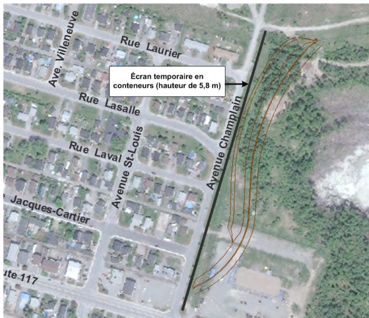
Figure 3 Emplacement de l'écran temporaire en conteneurs
