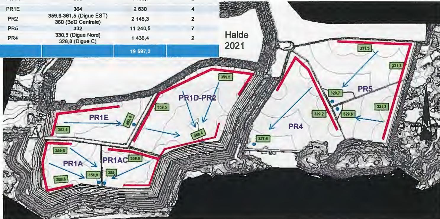
Important: La halde à stériles, au nord de la cellule PR5, doit être rehaussée à l'élévation 332 m (au minimum) en début d'année 2019.
