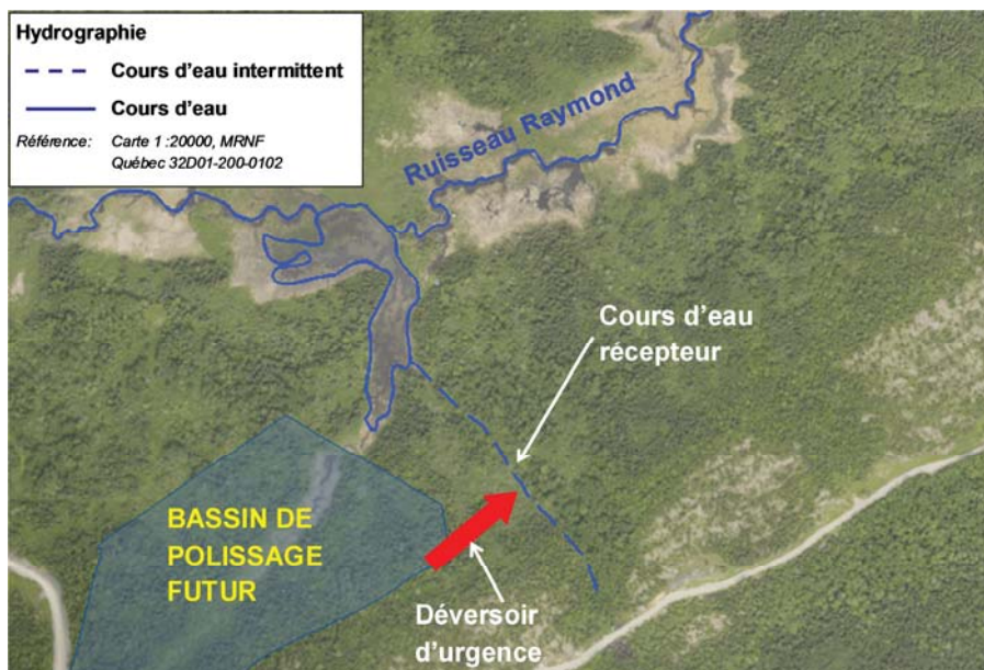
Illustration 4 – Localisation du cours d'eau récepteur en cas de déversement par le déversoir d'urgence du bassin de polissage futur
