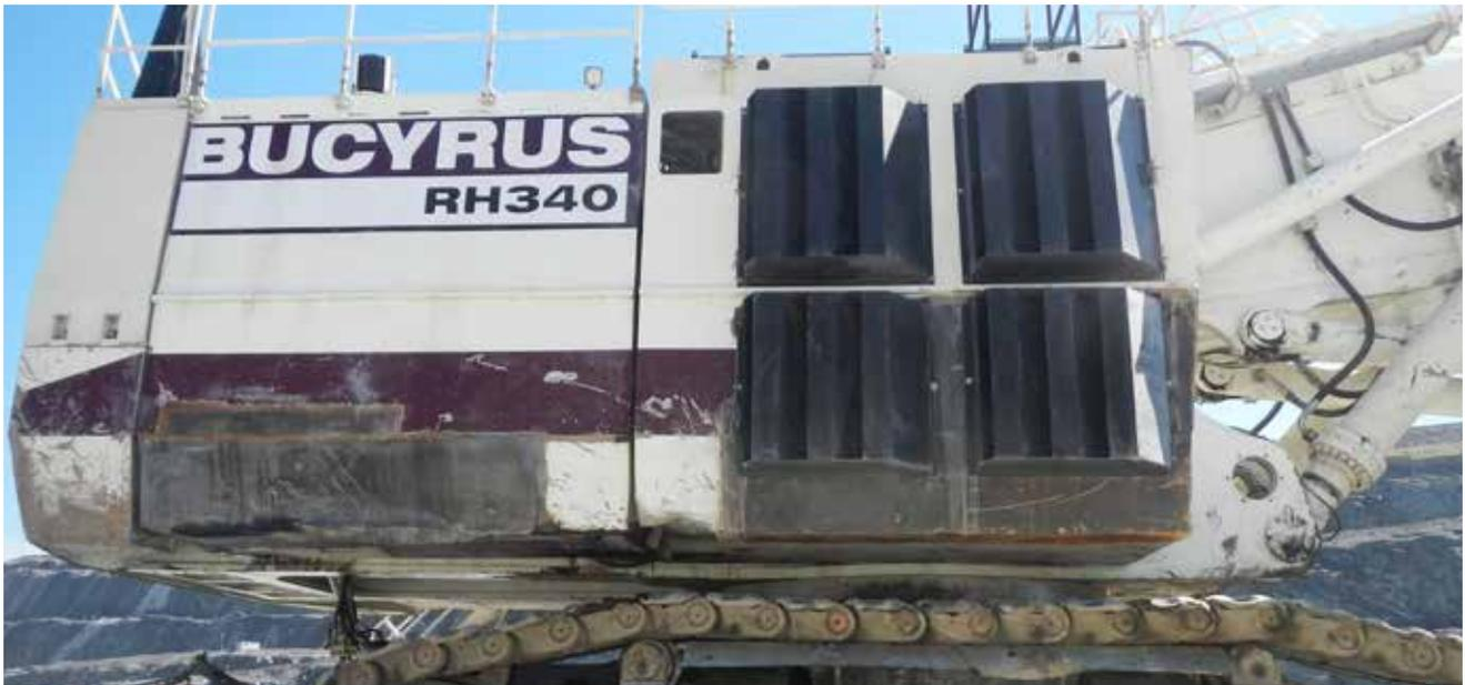
Dispositif de réduction du bruit installé sur un équipement minier.
