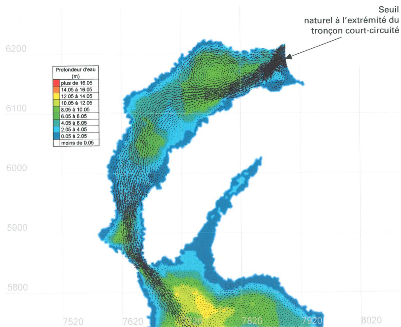
**Figure RQC-1.13a** Champ des vitesses d'écoulement superposé aux profondeurs, en conditions actuelles caractéristiques du mois de novembre, débit de la rivière Magpie de 146 m<sup>3</sup>/s (conditions de marée moyenne)
