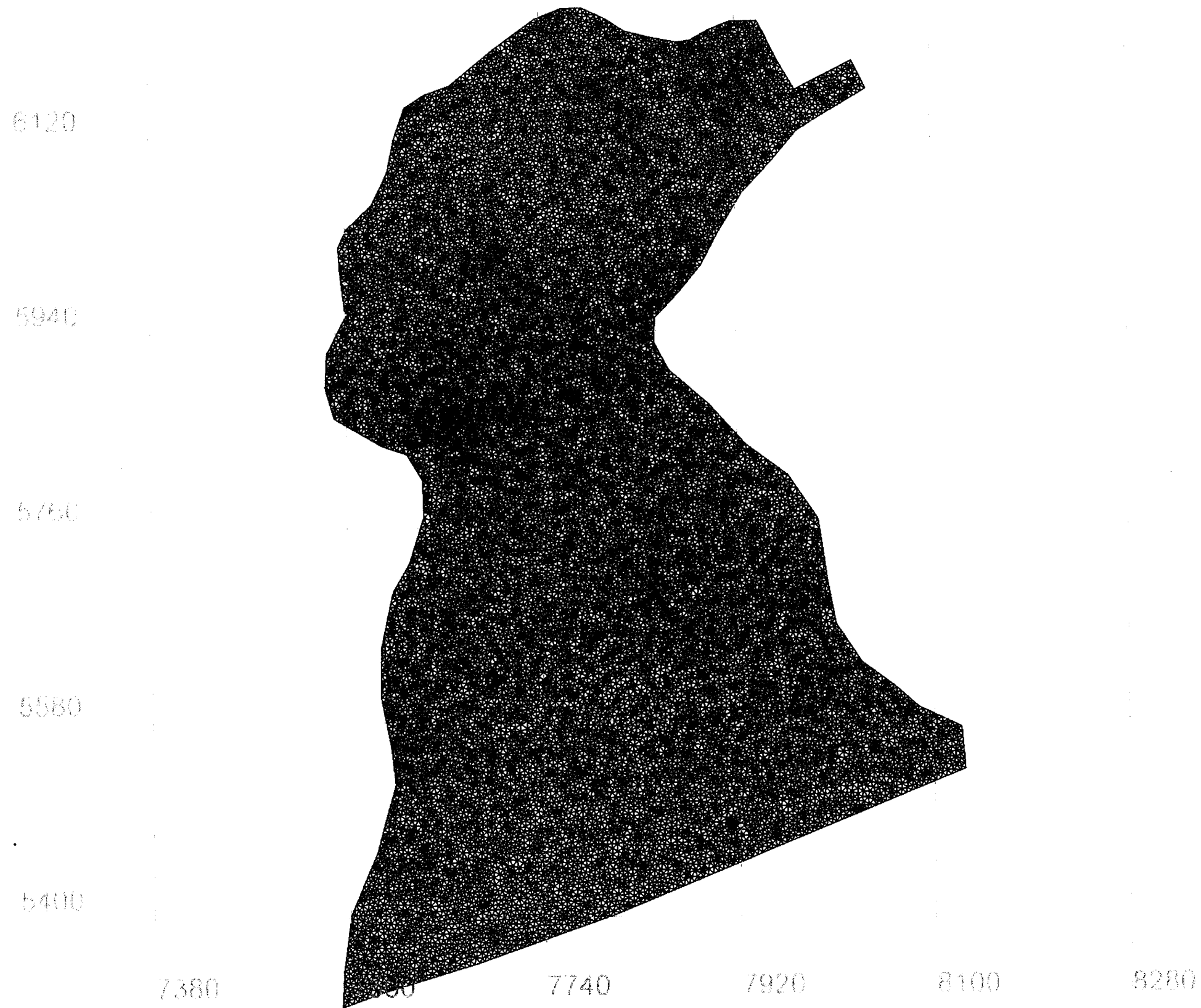
Figure RQC-46.1 Modèle de discrétisation géométrique du tronçon aval
