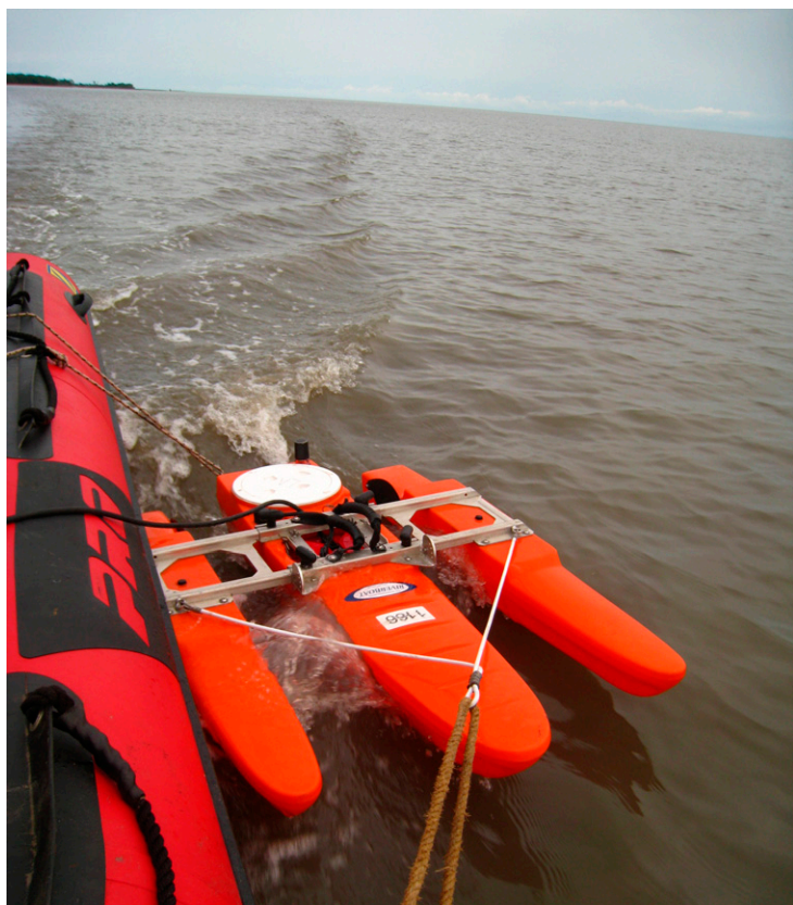
PHOTO 1 — Exemple du montage du courantomètre. Ce dernier (en blanc) est installé sur un radeau flottant tiré par un Zodiac
