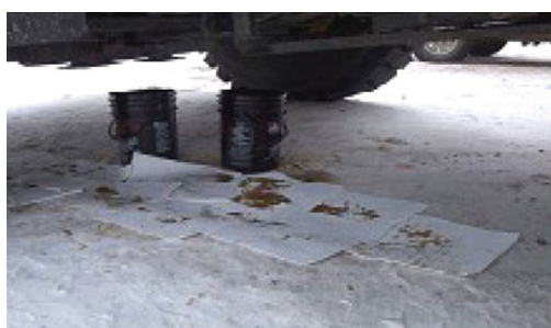
Photo I.2 : Feuilles absorbantes pour récupérer une fuite d'huile
