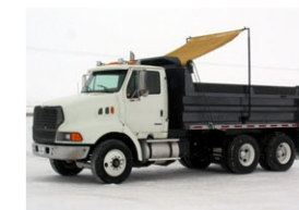
Photo J.3 : Camion muni d'une bâche
