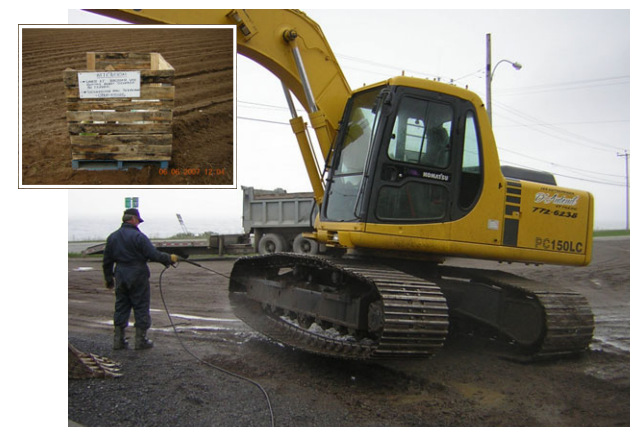
Photo D.7: Nettoyage à haute pression de la machinerie
