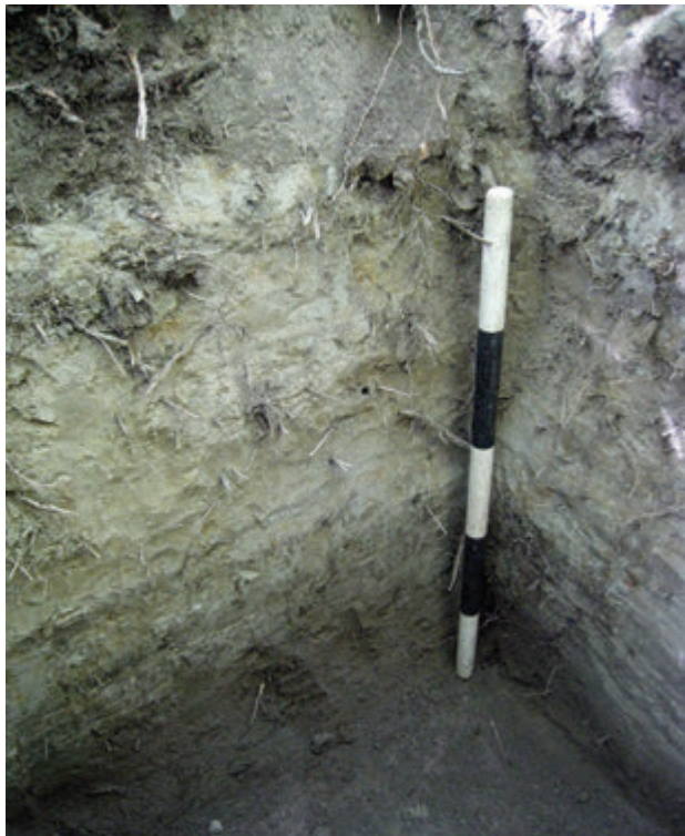
Photo 5 - Lot 3 294 072 – Sondage type montrant une succession de dépôts d’alluvions et de sédiments très fins. Profil stratigraphique de la paroi sud-ouest – Vue vers le sud-ouest (SLNGaz14-N1-047)
