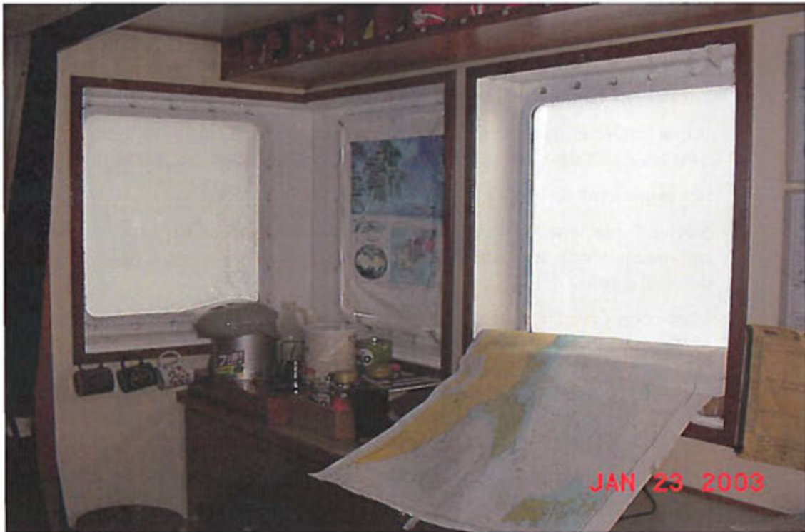
Figure 9.1A – Cartes de navigation utilisées comme isolant nuisant à la visibilité dans la timonerie
